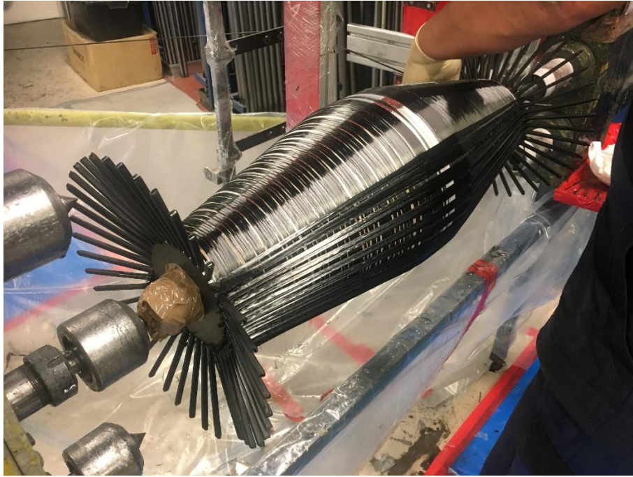
Obrázek č. 28: Absorbér v průběhu navíjení
