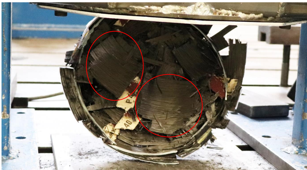
Obrázek č. 53: Podlomené segmenty skořepiny s nevhodným průběhem deformace
