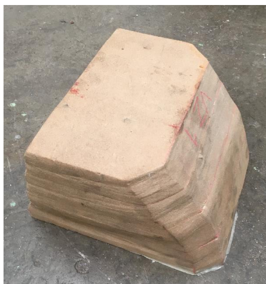
Obrázek č. 13: Pěnový absorbér po provedeném testování
