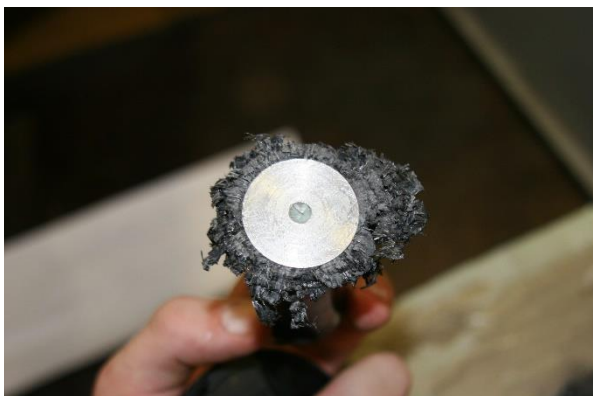
Obrázek č. 43: Deformovaná trubka s iniciátorem
