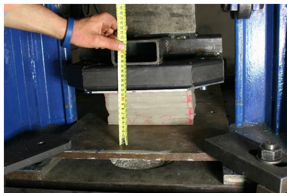
Obrázek č. 44: Absorbér po nárazu
