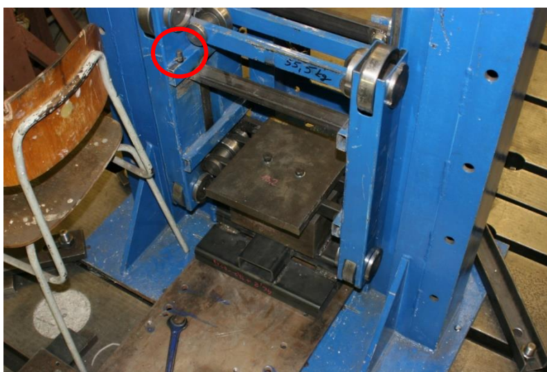
Obrázek č. 38: Umístění akcelerometru na padostroji bez přidané zátěže
