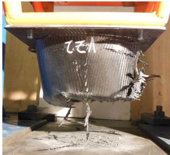
Obrázek č. 10: Absorbér po provedení zkoušky, eForce 2016
