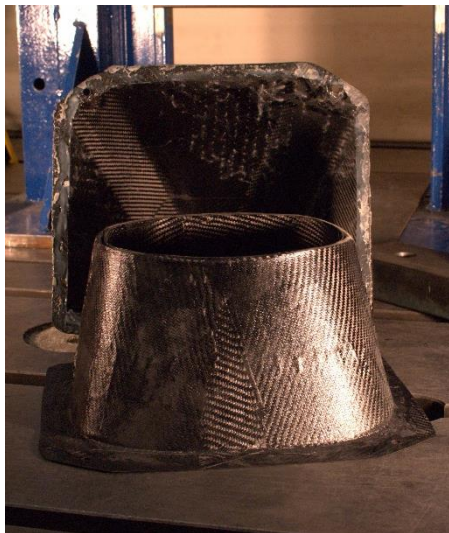
Obrázek č. 9: Uhlíkový absorbér, eForce
