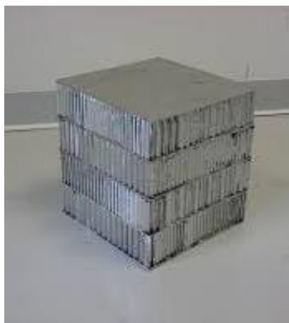
Obrázek č. 8: Absorbér z voštinových segmentů [6]
