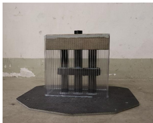
Obrázek č. 19: Absorbér z uhlíkových trubek a vedením z pěny
