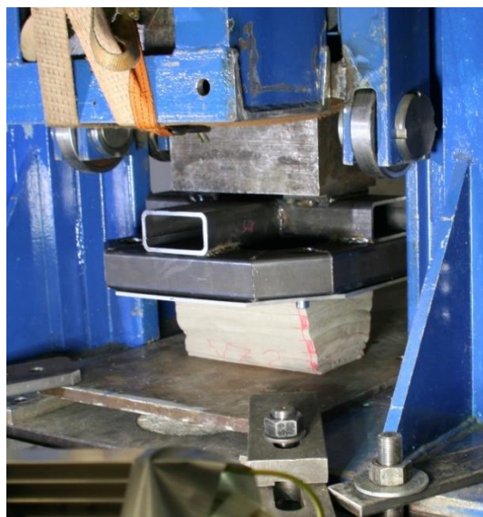
Obrázek č. 37: Přípravek uchycený na padostroji
