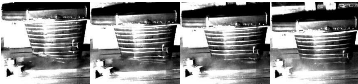
Obrázek č. 52: Pokračující deformace uhlíkového absorbérů
