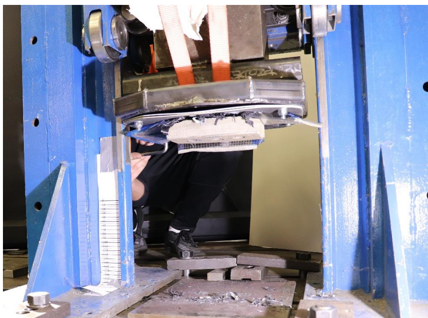
Obrázek č. 45: Absorbér po provedení zkoušky
