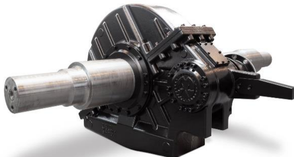
Obrázek 15: Převodovka pro jednotku metra (převzato z [25])
