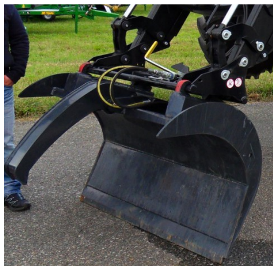
Obr. 19.: Rampovač na kulatinu [14]
