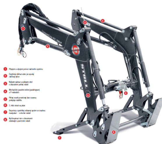
Obr. 10.: Čelní nakladač Stool FC 350 P s paralelogramem [10]
