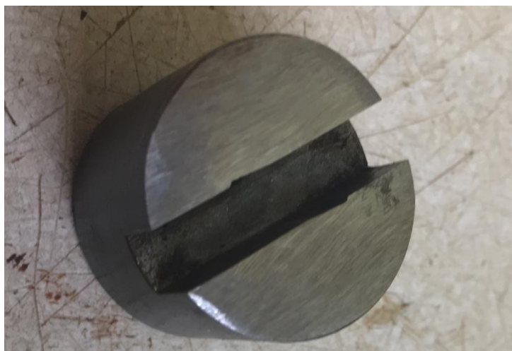
obr. 63.: Opotřebení na hřídeli motoru po zkouškách
