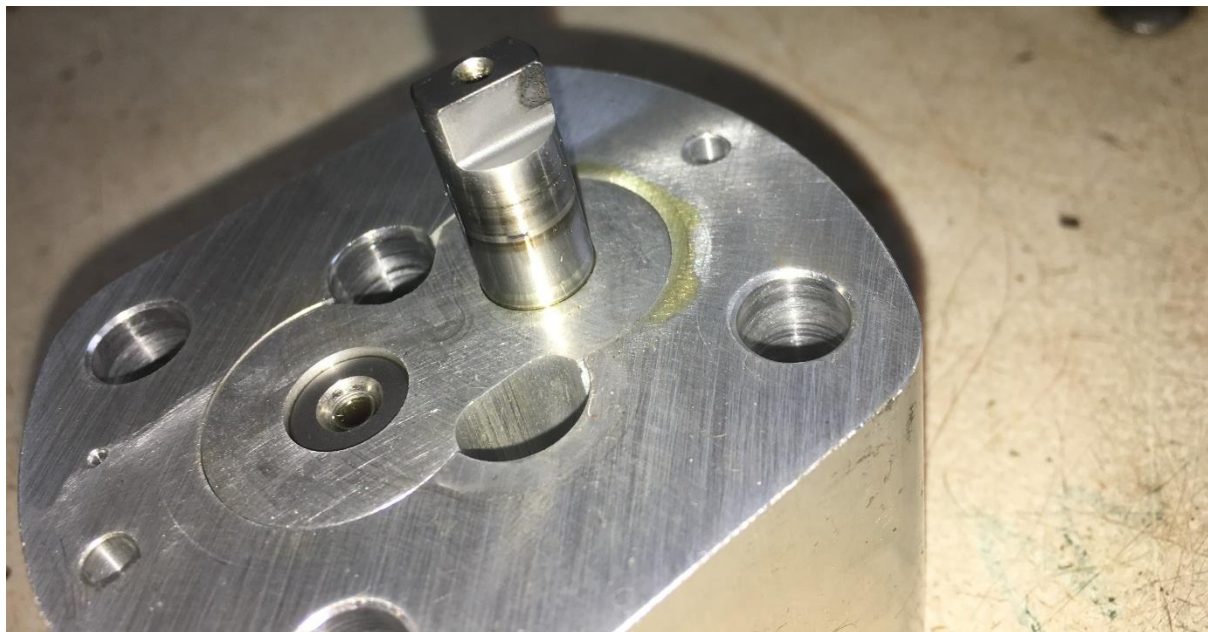
obr. 62.: Opotřebení na ozubeném hřídeli po zkouškách
