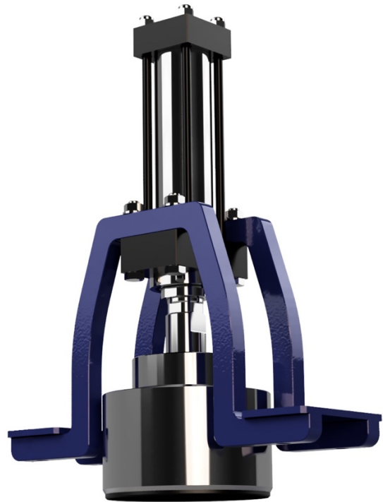
Obr. 58 - Zástavba infiltrometru zespoda
