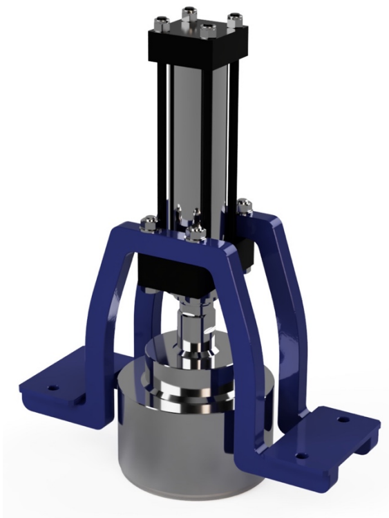
Obr. 57 - Zástavba infiltrometru shora
