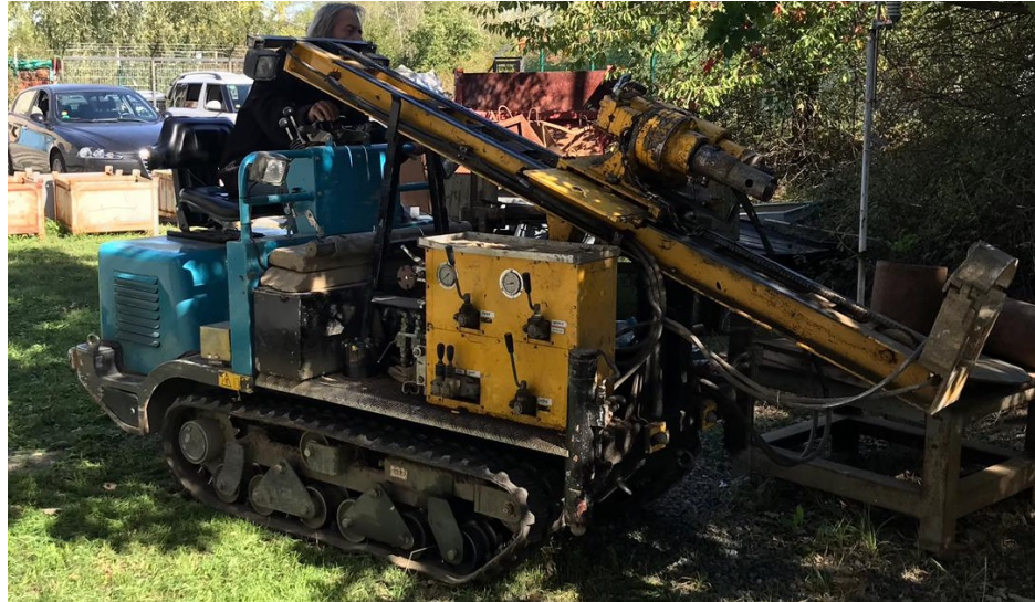
Obr. 25 - Pojízdné vrtací zařízení RDBS mini (zdroj tlakové síly)
