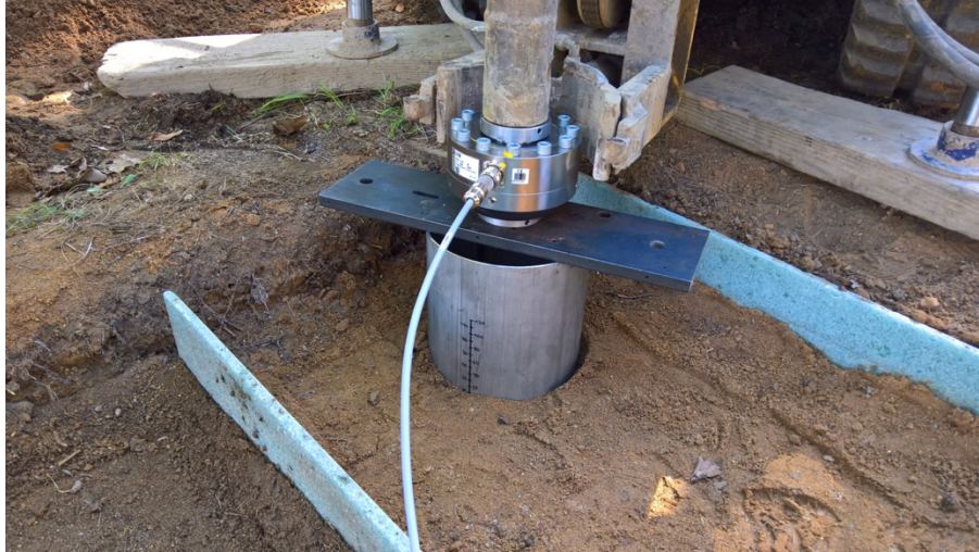
Obr. 28 - Měřicí soustava – infiltrační válec, podložka, silový snímač, vrtací zařízení
