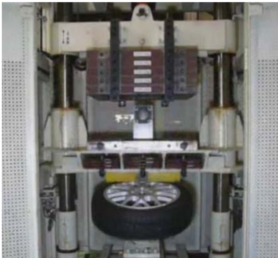
Obr. 4.6 Fotografie EHK 124 - Zkouška nárazem [14]
