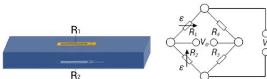
Obr. 2.7 Schéma zapojení a instalace tenzometru - Jednoduchý půlmůstek [5]
