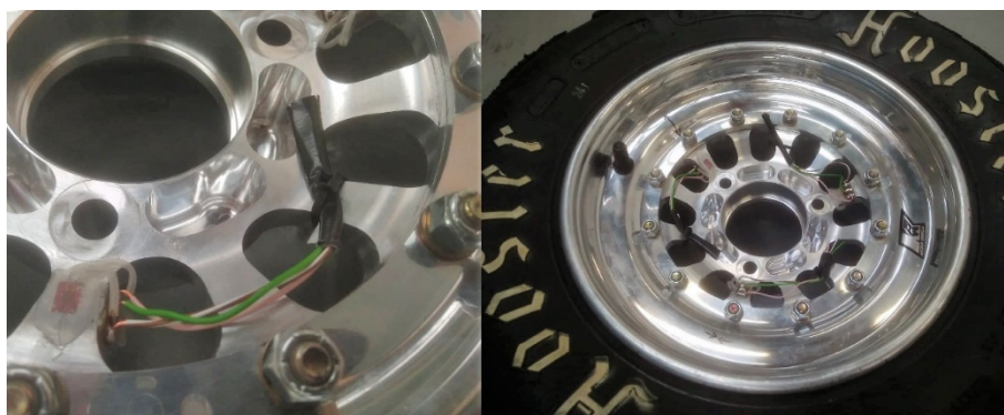
Obr. 6.4 Tenzometry zapojené pro měření
