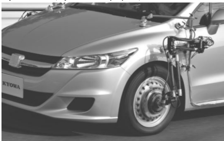
Obr. 3.2 6-komponentní systém měření síly kola firmy Kyowa [17]
