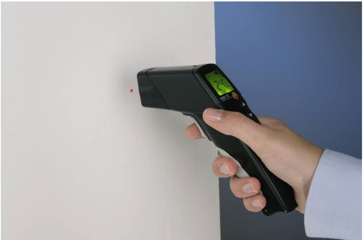
Obr. 4: Měření IČ teploměrem(pyrometrem), kde červená téčka ukazuje bod, ve kterém se měří teplota [10]
