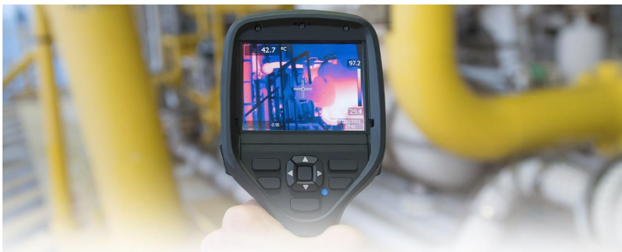
Obr. 1: Měření teploty bezkontaktním způsobem [8]
