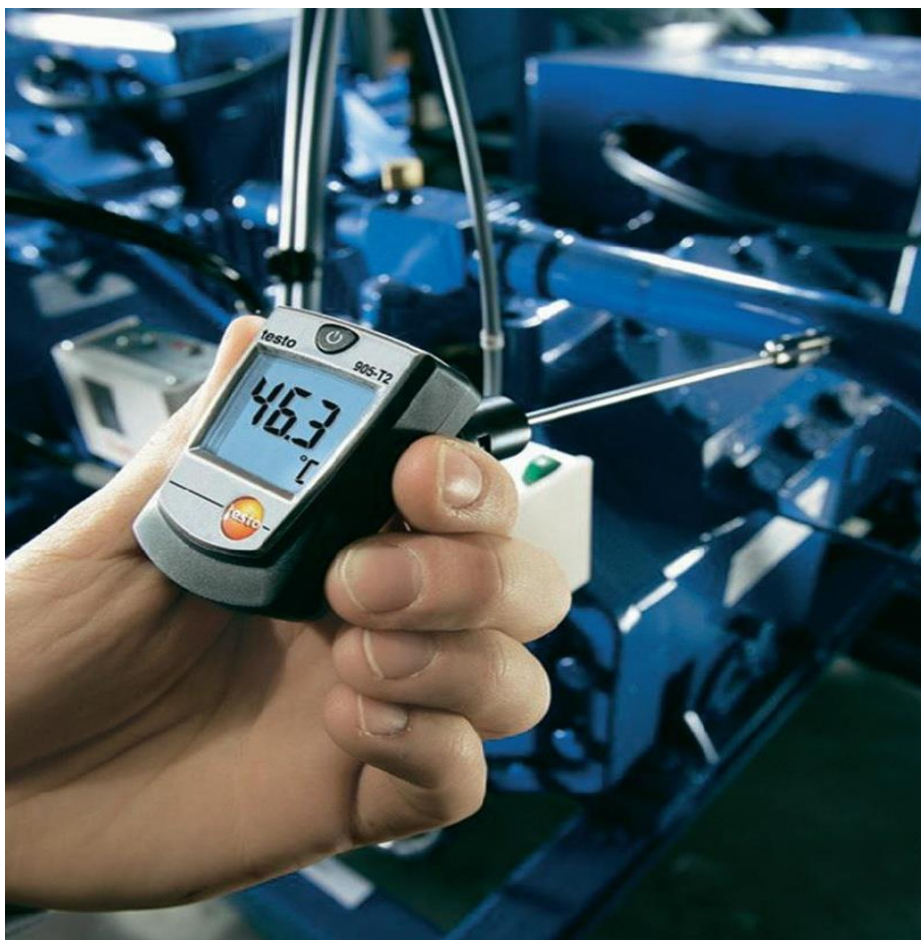
Obr. 13: Stanovení teploty dotykovým teploměrem [15]
