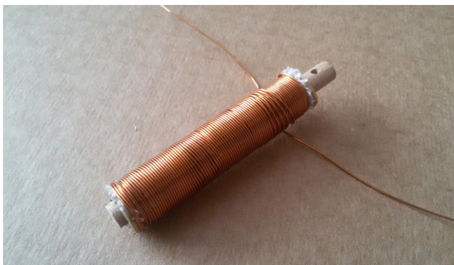
Obr. 29 Cívka pro finální laboratorní model
