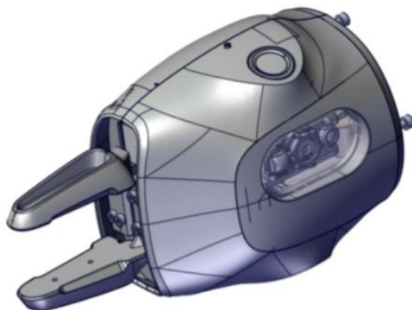
Obr. 64 - Smart gripper vybavený standardními prsty [27]
