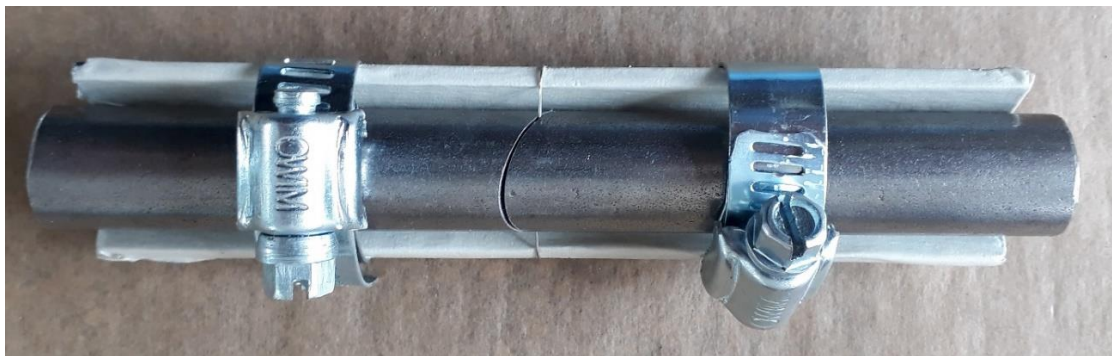
Obr. 15 Zostavený fixačný prípravok bez naneseného adhezíva
