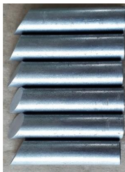
Obrázok 12 Vzorky pre statickú ťahovú skúšku pred lepením
