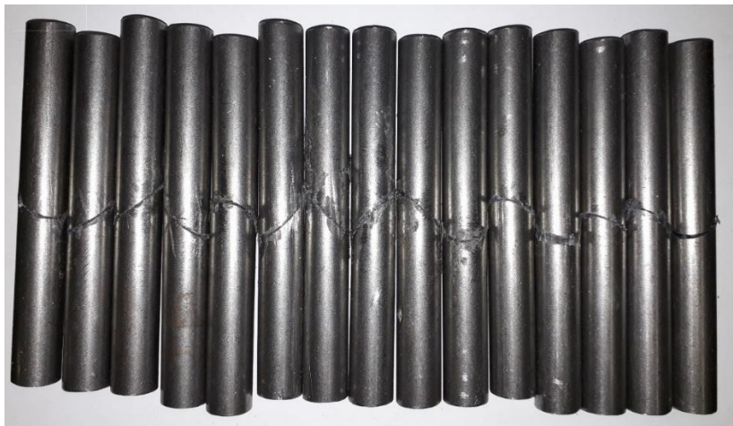
Obr. 18 Vzorky po odstránení prebytočného adhezíva
