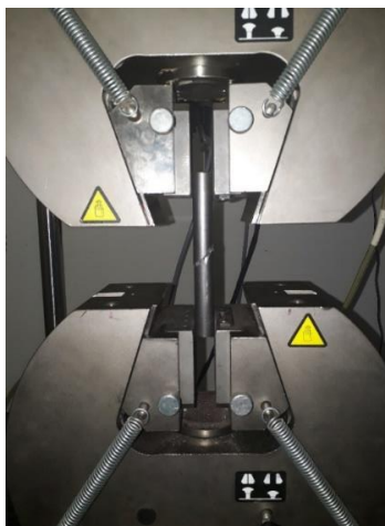
Obr. 20 Vzorka v čelustiach uhol 45°
