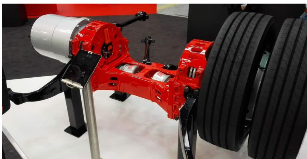
Obr. 14 Náprava E-Traction na veletrhu IAA v Hannoveru 2018
