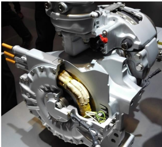
Obr. 16 Řez nápravou ZF AVE130 ze strany elektromotoru Obr. 17 Řez nápravou ZF AVE130 ze strany kola
