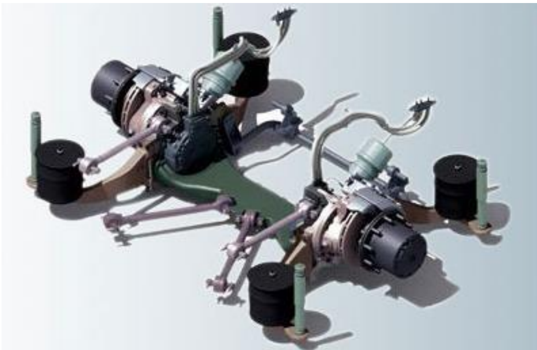
Obr. 18 Náprava BYD s PMSM elektromotory [20]
