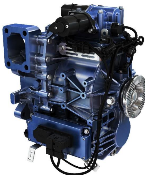
Obr. 20 Čtyřstupňová převodovka EATON [22]
