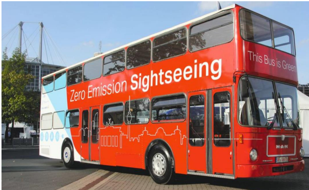
Obr. 12 Přestavba starého autobusu na elektrobus s nápravou Ziehl-Abegg na veletrhu v Hannoveru 2018 [19]
