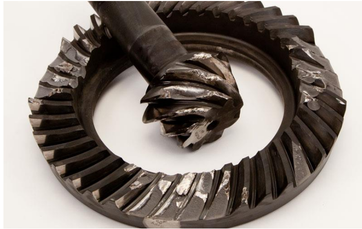
Obrázek č. 18: Lom v důsledku přetížení ozubení [19]
