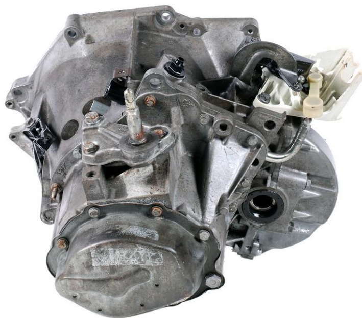
Obrázek č. 8: Převodový agregát Peugeot 20DM75 – pohled od skříně převodovky [9]
