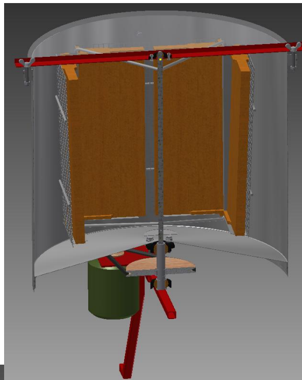
obr. 40.: Řez celým medometem [Inventor]
