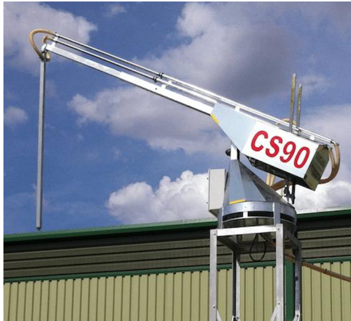
Obr. 3 Vzorkovač zrnin s elektrickým pohonem společnosti TecPro [4]
