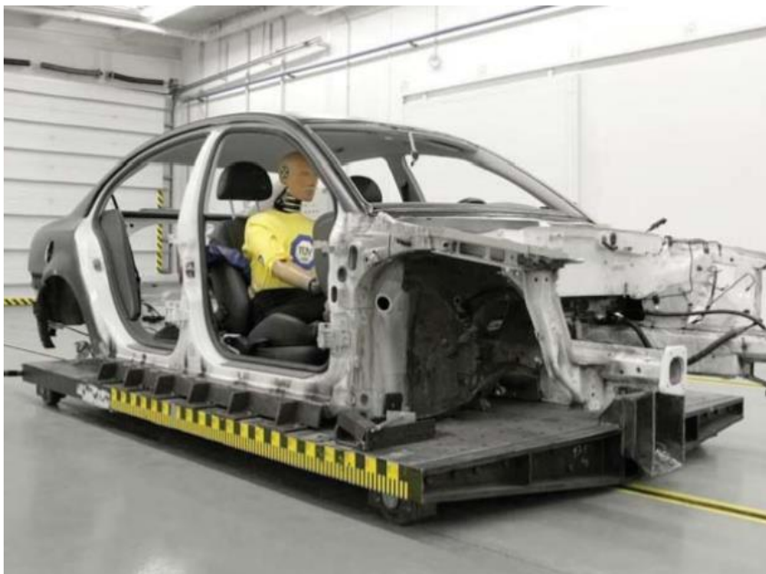
Obr. 3.: Rám vozidla pro upevnění zkoušených komponent na saňové dráze [4]
