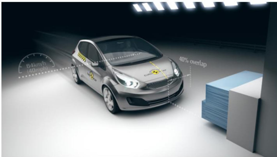
Obr. 2.: Euro NCAP ODB test [1]
