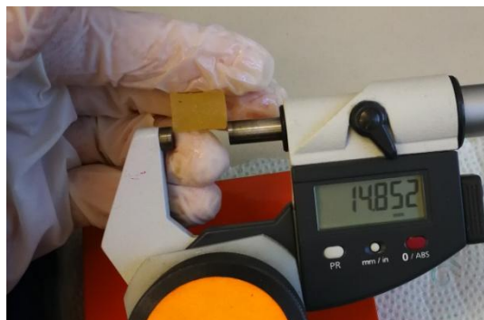
Obrázek 19: Provedení experimentu: a) vyjmutí vzorků z nálevu a přiřazení pořadového čísla, b) měření průměru a výšky
