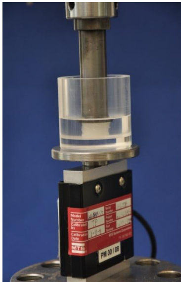
Obrázek 20: a) axiální zatížení vzorku v příslušném nálevu, b) zatížení suchého vzorku
