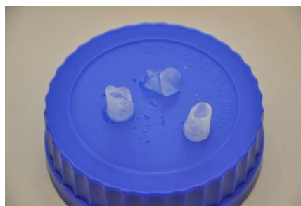
Obrázek 27: a) vzorky degradované 14 dní v krevní plasmě, b) vzorky degradované 14 dní v SBF
