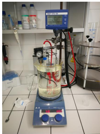
Obrázek 15: Příprava SBF: Rozpuštění přísad v ohříváné destilované vodě při současném měření pH
