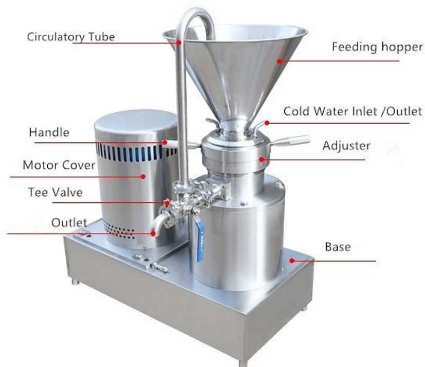
Obrázek 43; Příklad koloidního mlýna používaného pro farmaceutické účely [28]
