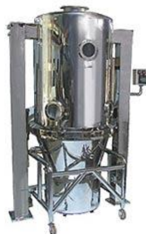
Obrázek 51; Fluidní sušárna používaná ve farmacii [38]
