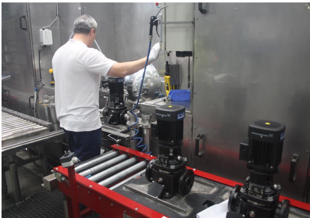
Obrázek 9 - Automatická montážní linka oběhových čerpadel
