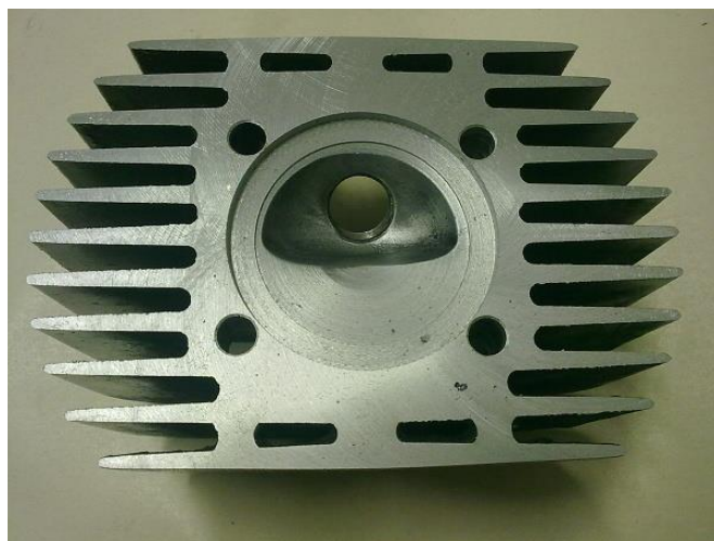
Obr. 17. Originální hlava válce, upravená pro zvětšení kompresního poměru [21]
