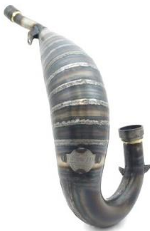
Obr. 8. Výfuk Scalvini pro motocykl KTM sx125, vyroben z plechových výlisků a zakružených komolých kuželů [14]
