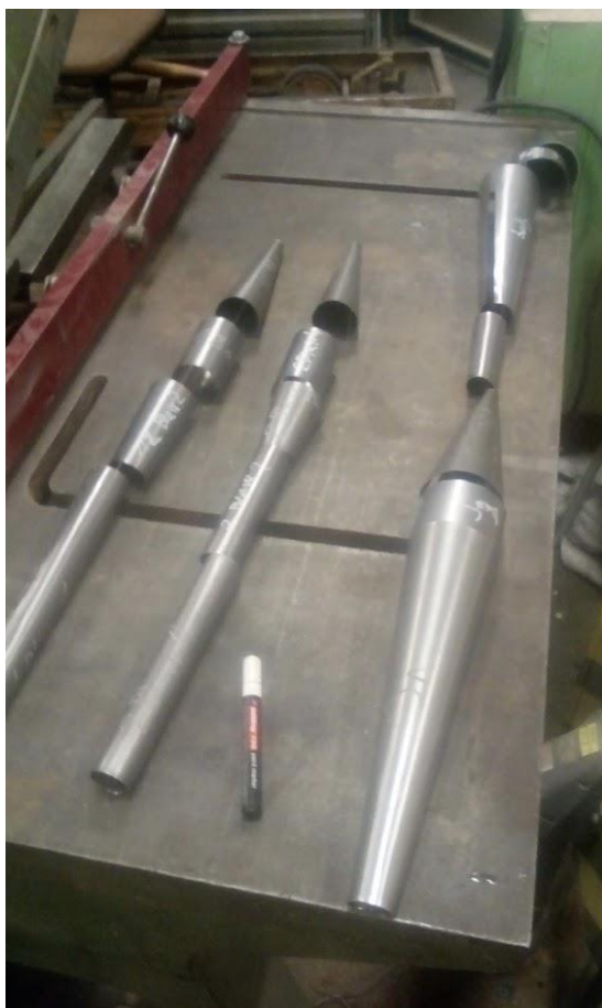
Obr. 43. Zakružené profily připravené ke svařování
