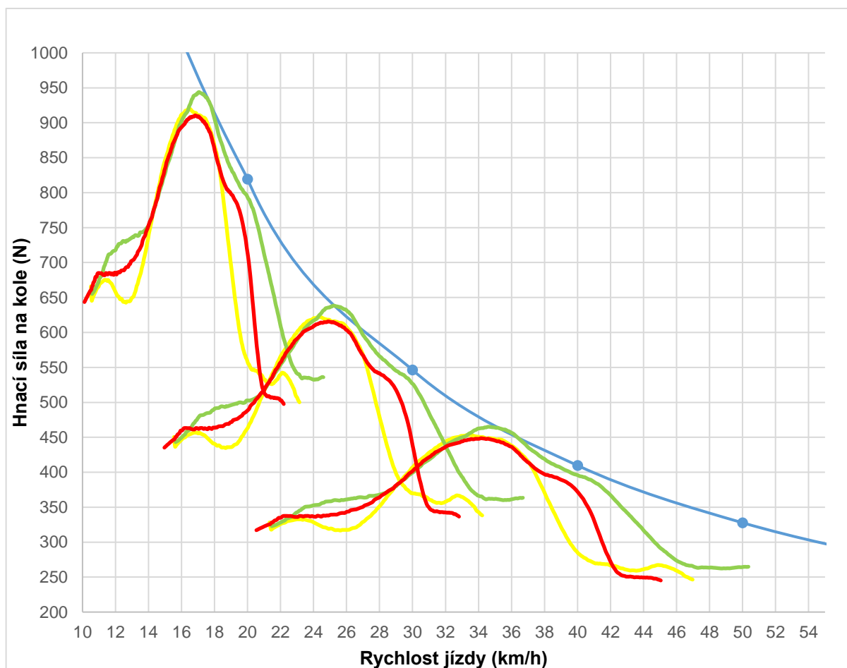
Graf 10. Graf porovnání závislosti hnací síly na kole motocyklu s jednotlivými variantami výfuku podle Jenningse (modrá), Bella (červená) a Blaira (zelená)
