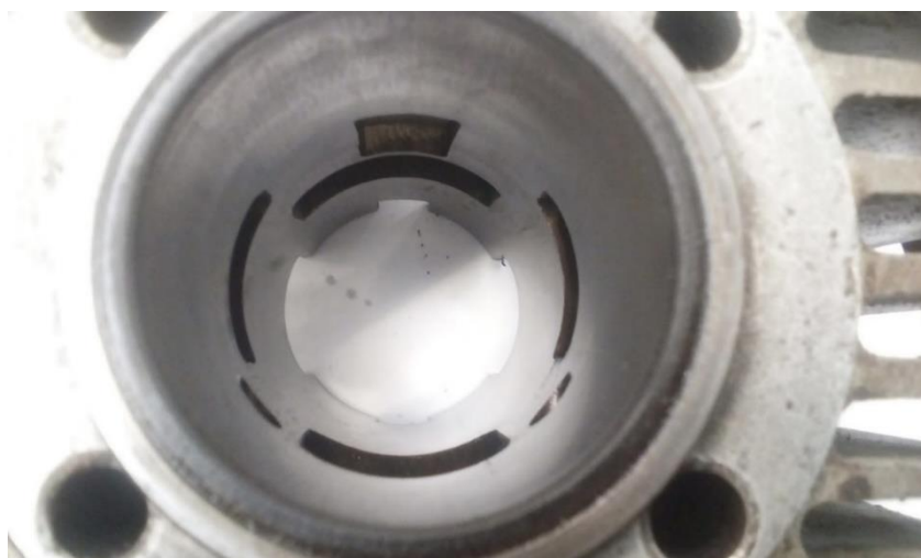
Obr. 15. Hotová úprava válce motoru
