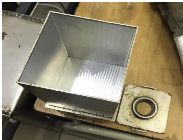
Obr. 8 Použitá forma na vzorky
