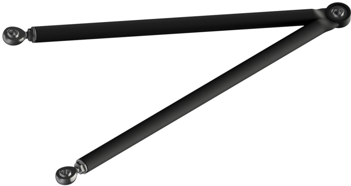
Obr 19. Chrom-molybdenové rameno FSE.08
