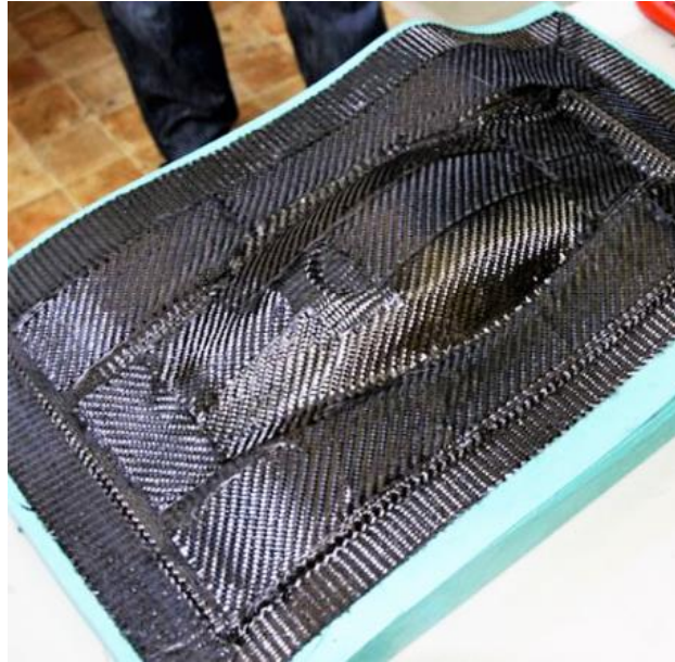
Obr 7. Skládání z prepregu [11]
