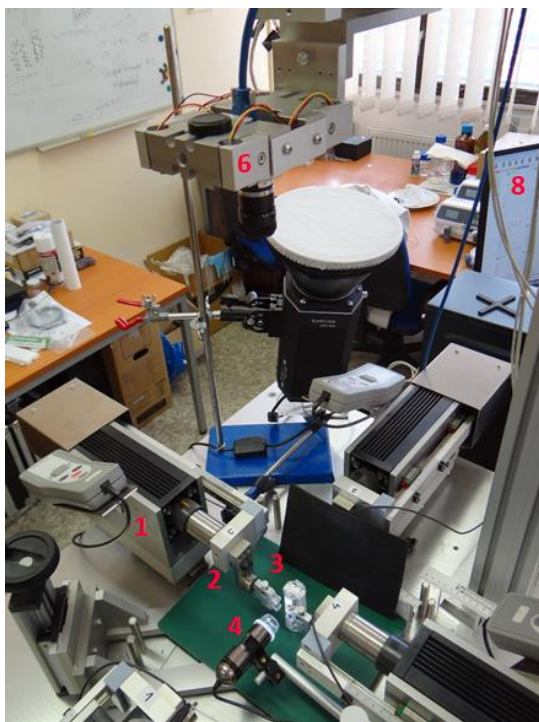
Obrázek 51: Reálné uspořádání experimentu, 1 = aktuátory, 2 = siloměry, 3 = čelisti aktuátorů, 4 = mikroskop, 6 = videoextenzometr, 8 = počítač
