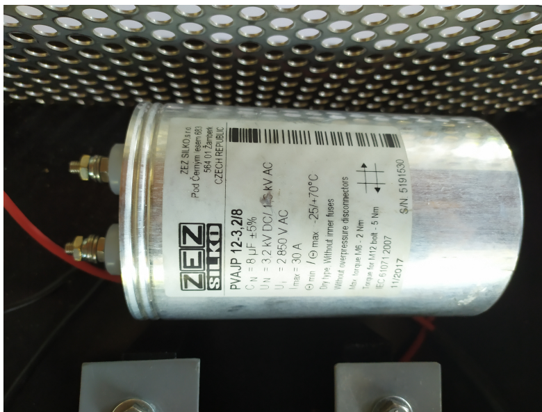
Obrázek 3.10: Testovací kondenzátor 8 \mu\text{F} – PVAJP 12-3,2/8
