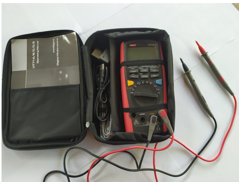
Obrázek 3.15: Multimetru UNI-T UT71B použitý pro ověření vypočtené hodnoty
