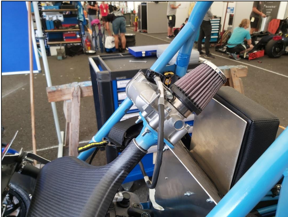
Obr. 5.: Využitie Bosch elektronickej klapky na monoposte tímu Rhein Mosel Motorsport
