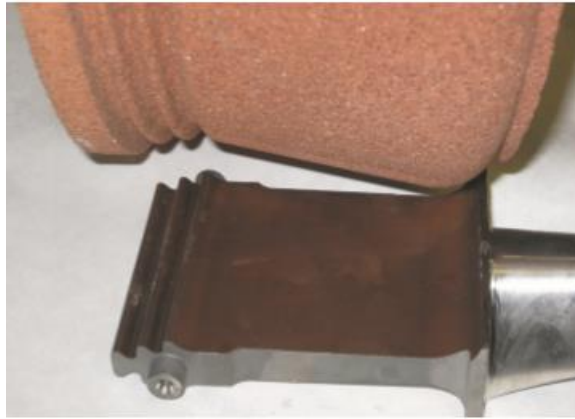
Obr. 11 - Broušení lopatek profilovými kotouči [17]
