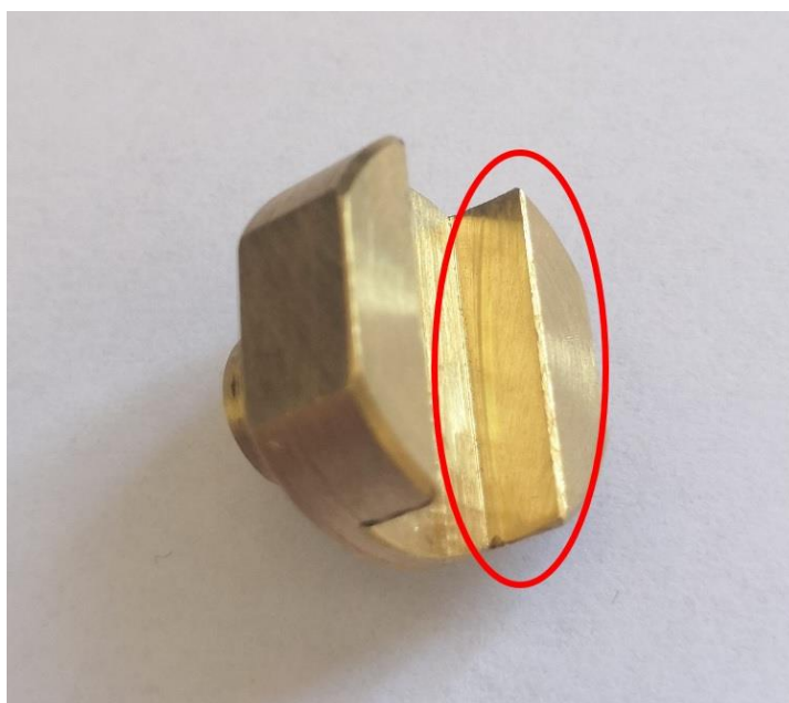
Obrázek 43: Řadicí kamen 5. rychlostního stupně po 2010 přeřazeních
