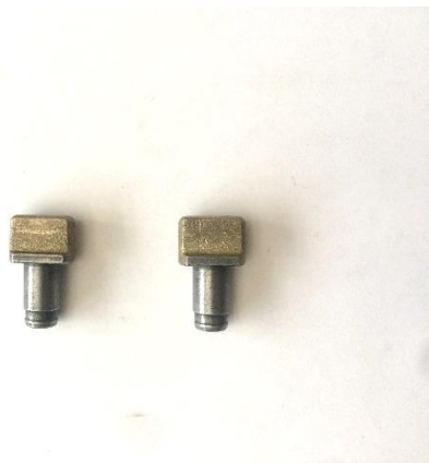
Obrázek 17: Vyjímatelné řadicí kameny
