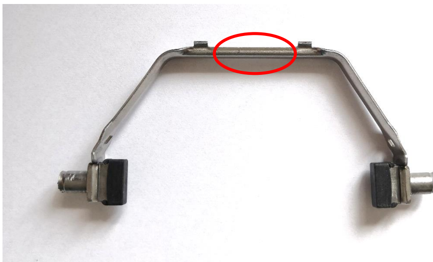
Obrázek 20: Nová verze řadicích kamenů s tříbodovým stykem (zakroužkováno)
