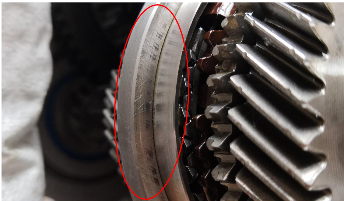
Obrázek 49: Řadicí objímka po 80 000 zařazeních
