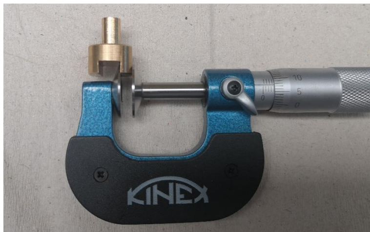
Obrázek 44: Měření tloušťky boků řadicích kamenů 3. a 4. rychlostního stupně
