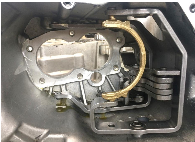
Obrázek 15: Půlměsíkový řadicí kamen s trojbodovým stykem
