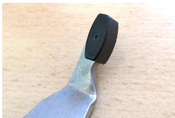
Obrázek 22: Řadicí kamen V. rychlostního stupně (nová verze)
