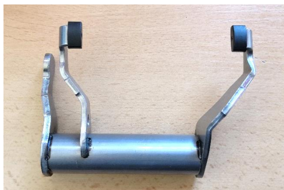
Obrázek 21: Řadicí vidlička V. rychlostního stupně (nová verze)
