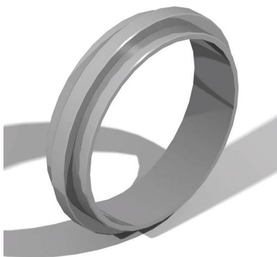
Obrázek 24: Model prototypu řadicí objímky
