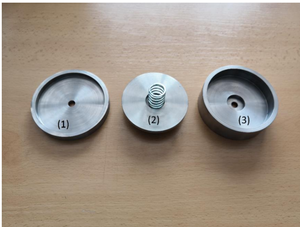
Obrázek 31: Přípravek pro výrobu prototypu řadicí objímky – rozebraný stav
