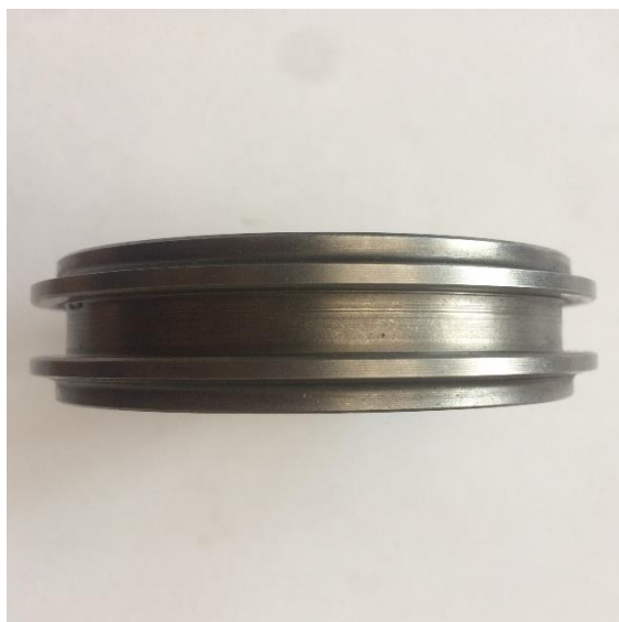
Obrázek 23: Původní řadicí objímka s drážkou
