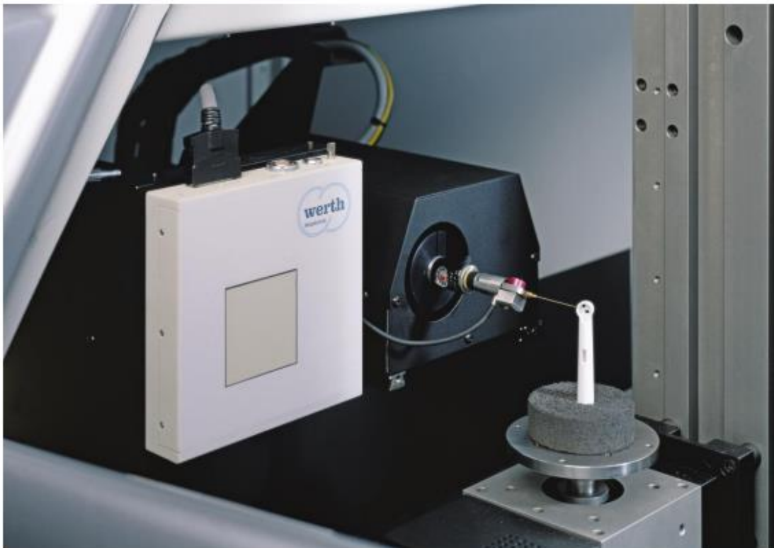
Obr. 10 - Měření dílce s použitím doplňkového dotykového senzoru (převzato z [9])
