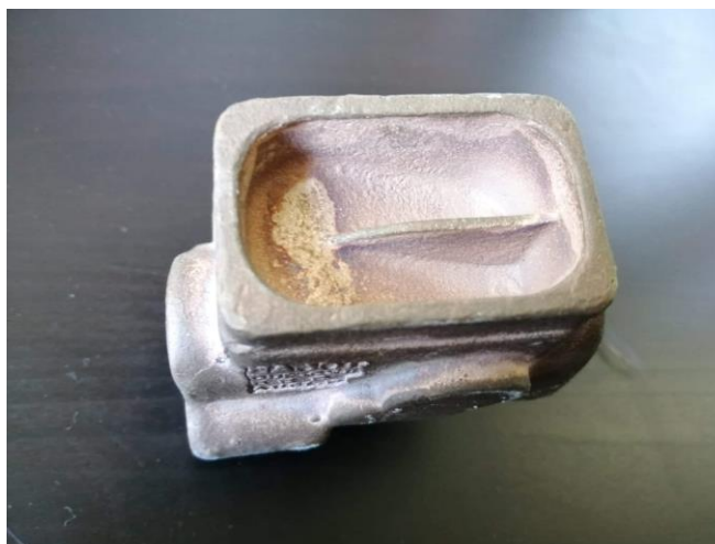
Obr. 29 - Komora na spodní části čerpadla
