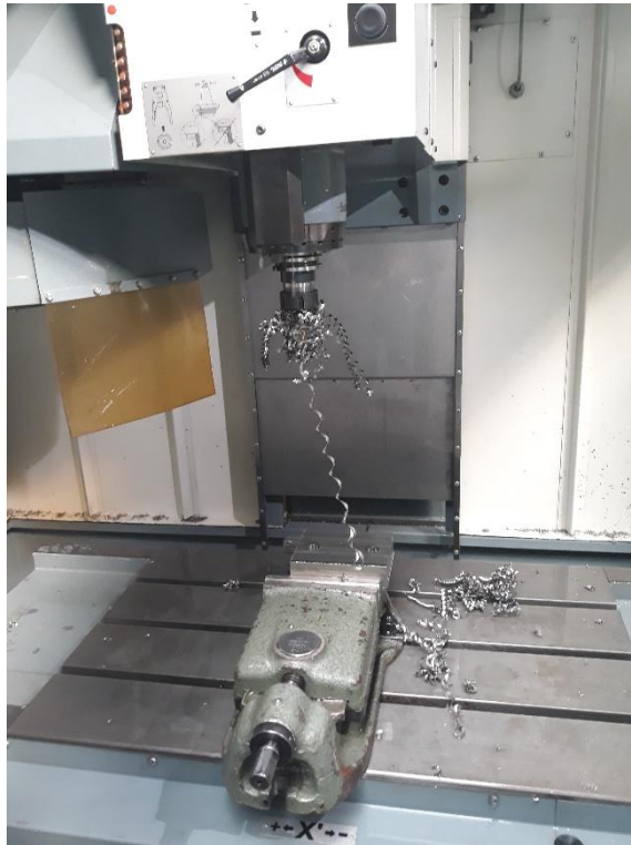
Obrázek 6.10. – Třísky se namotávají na nástroj během výroby desky a musí být před pokračováním odstraněny
