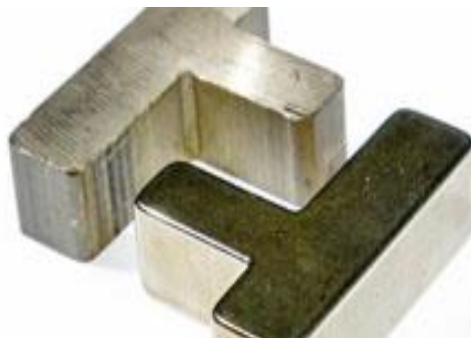
Obrázek 2.2 - součásti se zaoblenými hranami [12]
