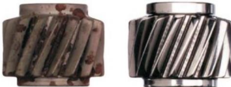
Obrázek 2.3. - Zuby šikmého ozubeného kola před a po omílání urychleném chemicky [8]
