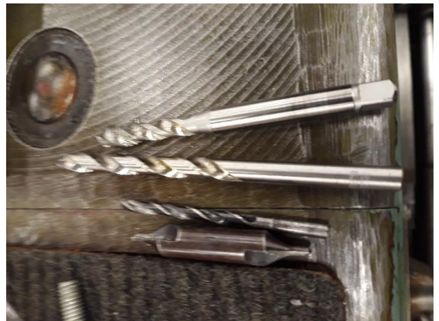
Obrázek 6.7. – nástroje použité při vyvrtání díry a následném vyřezání závitu
