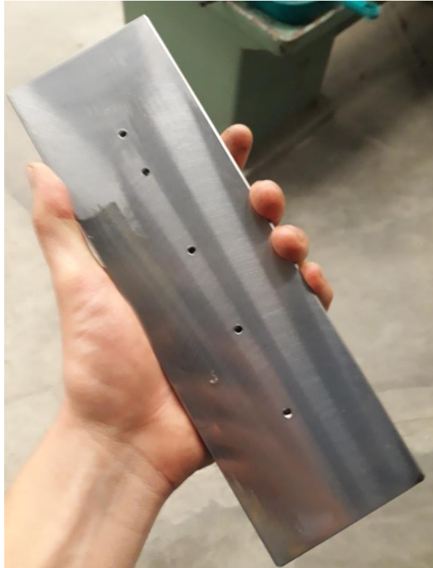
Obrázek 6.11. – Podkladová deska pod titan po dokončení výroby
