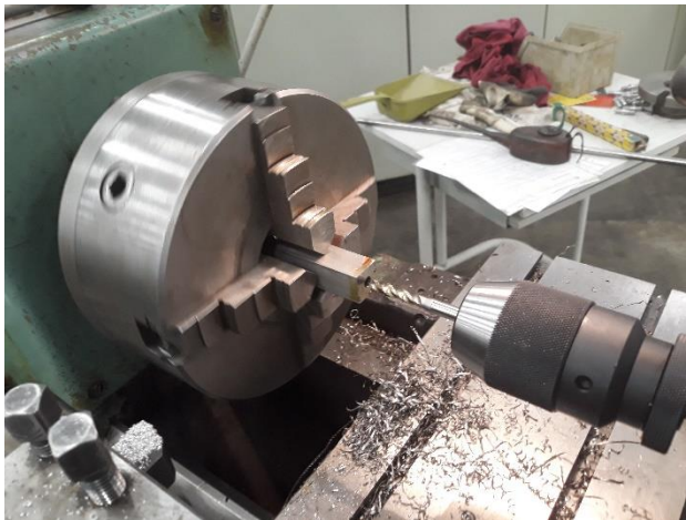
Obrázek 6.6. – Vrtání díry do čela tyče
