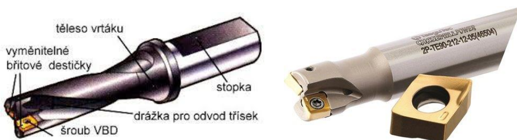
Obr. č. 20 a 21 Vrták s vyměnitelnými břitovými destičkami [53] [54]
