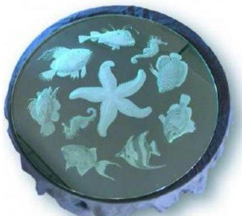
Obr. č. 5 Ukázka gravírovaných reliéfů do skla pomocí technologie AWJ (drobné detaily byly dokončeny ručně – broušením) [47]
