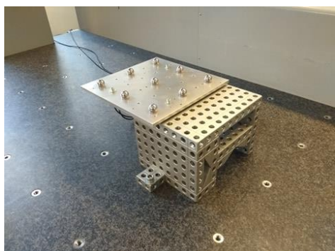
Obr.28: Snímací systém použitý pro obě zkoušky a zkušební těleso.
