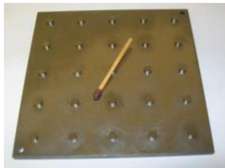
Obr. 19: Tzv. Cylinder plate pro \mu CMM. Zkouška s tímto artefaktem probíhá na stejném principu. [32]
