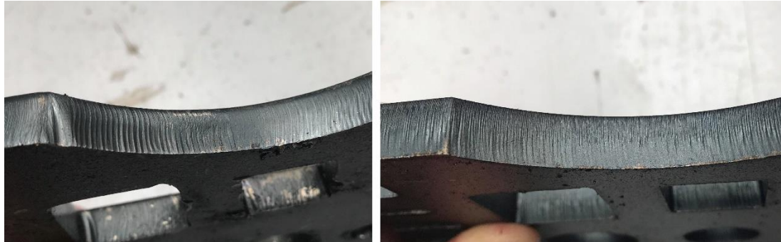
Obr. 23: Porovnání plochy řezu vlny vyřezané plasmatem (vlevo) a laserem (vpravo), ;Zdroj: autor
