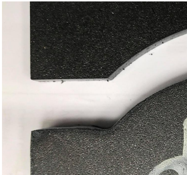
Obr. 24: Znázornění přechodů u úseků, které následují prudkým změnám směru řezu, u vzorků vyřezaných laserem (nahore) a plasmatem (dole); Zdroj: autor
