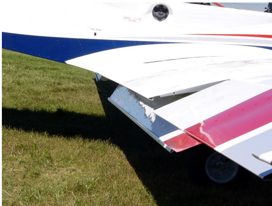
Obrázek 3 - Odštěpná klapka letounu Evekotor SportStar [7]
