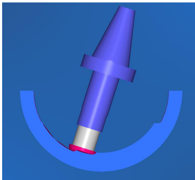
Obrázek 30: Obrábění druhé fáze metodou 4D řádkování
