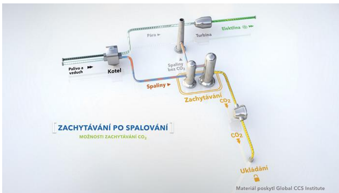
Obr. 5: Schéma separace CO 2 po spalování (post-combustion) [5]
