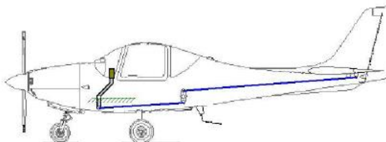
Obr. 4 Mechanický systém řízení táhly (Zdroj: Převzato z [2])
