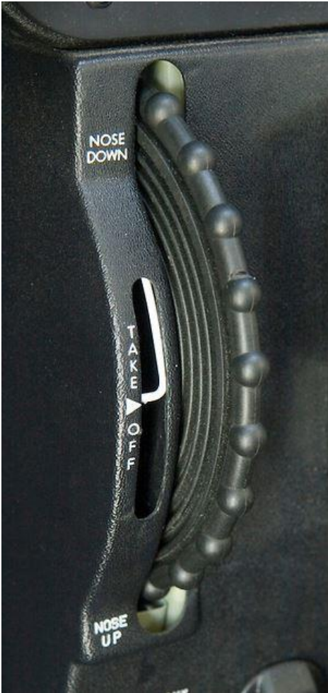
Obr. 9 Trimovací kolo (Zdroj [O9])
