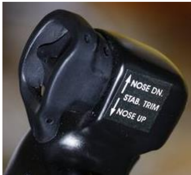
Obr. 10 Ovládání trimu na beranech B737 (Zdroj [O10])
