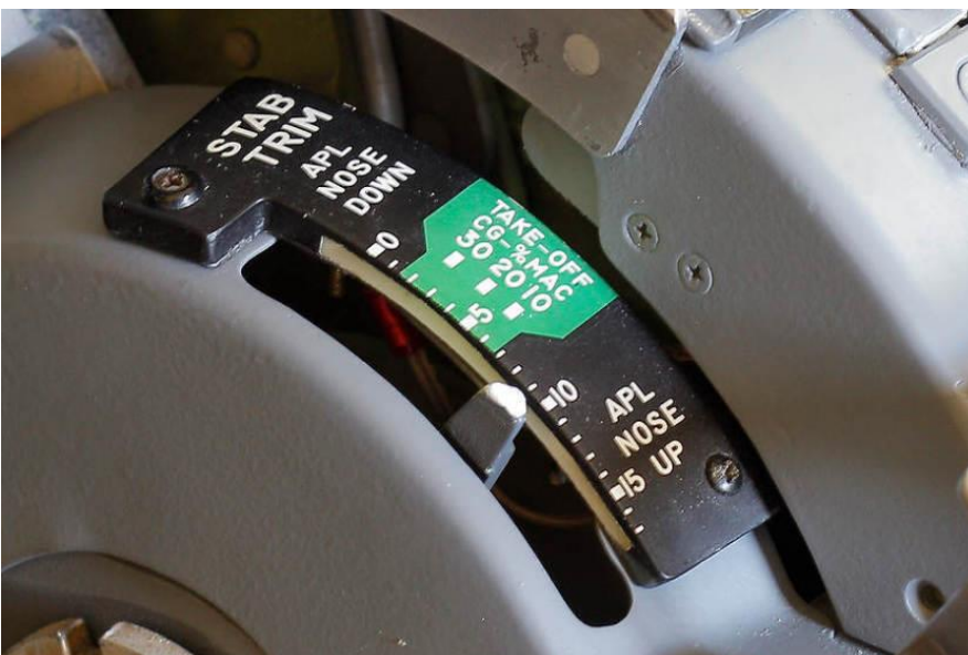
Obr. 11 Indikátor trimu B737 (Zdroj [O11])
