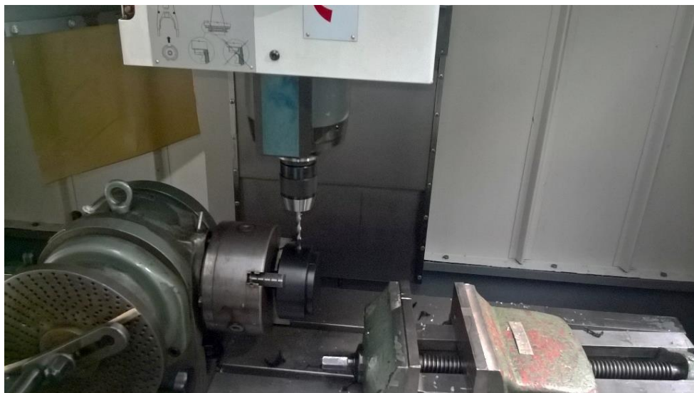
Obrázek 50: Horní kryt - upnutí v děličce, vrtání
