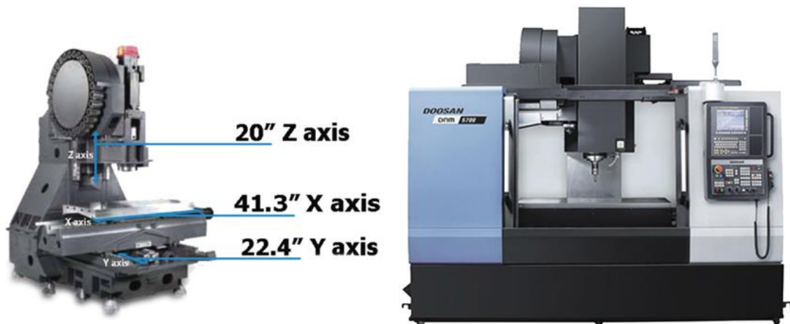
25 Grafické znázornění pojezdů stroje s uvedením rozsahu a celkový pohled na stroj doosan DNM 5700[16]
