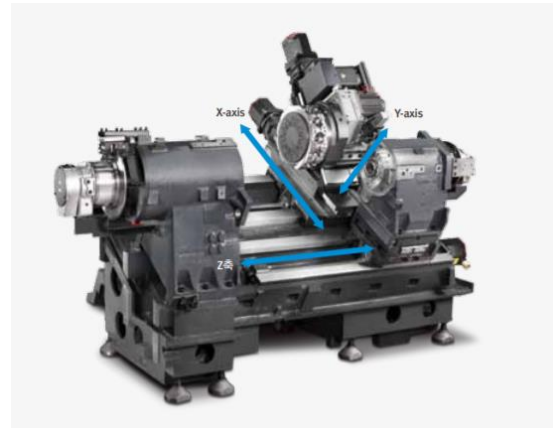
24 grafické znázornění pojezdů soustruhu doosan puma 2100 MS [15]
