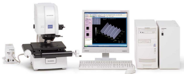
Obrázek 7 - Laserový konfokální mikroskop OLYMPUS [20]
