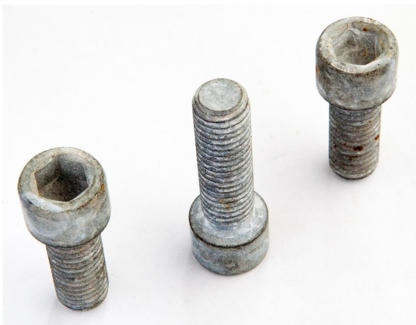
Obrázek 30 - Šrouby s PÚ lamelárního zinku po 240 hodinách v NSS
