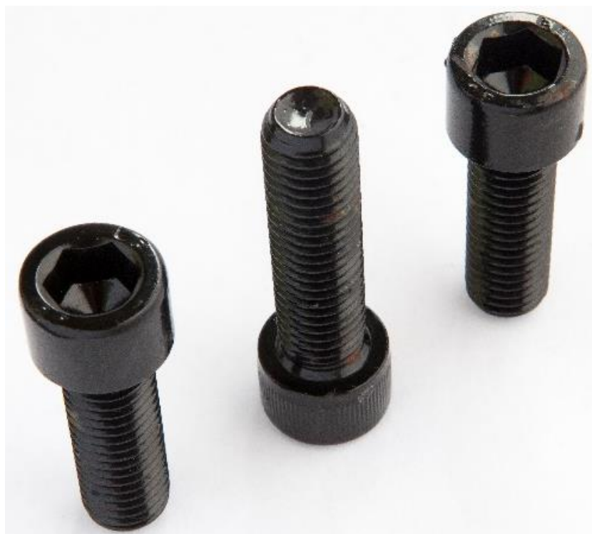
Obrázek 18 - Šrouby po 320 hodinách v NSS
