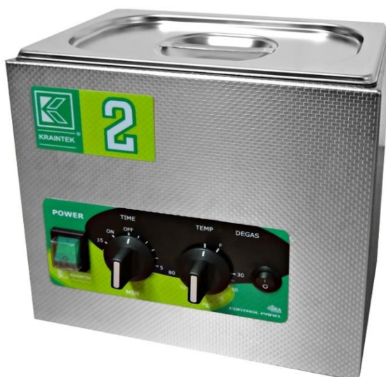
Obrázek 3 - Laboratorní ultrazvuková vana KRAINTEK [26]
