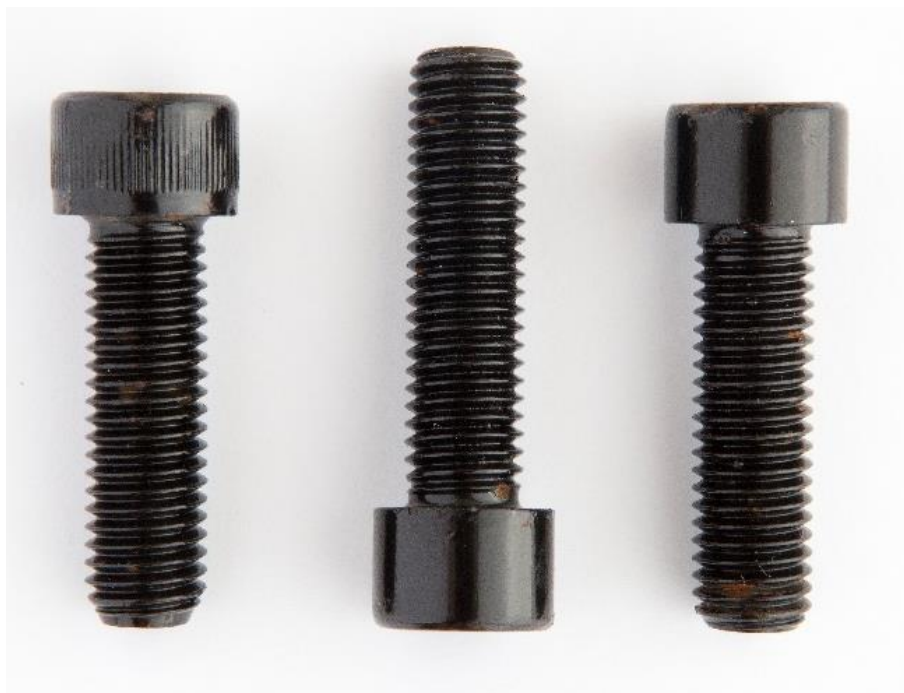
Obrázek 23 - Šrouby po 320 hodinách NSS
