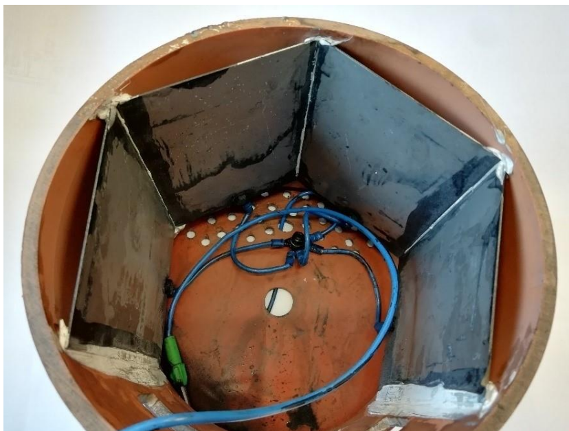
Obrázek 4 - Ukázka konstrukce kataforetického bubnu [23]
