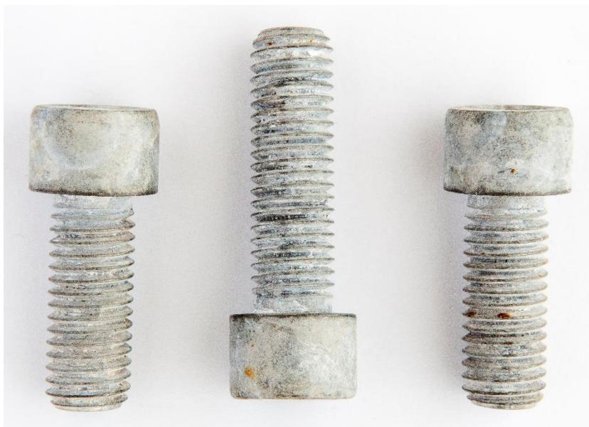
Obrázek 29 - Šrouby s PÚ lamelárního zinku po 240 hodinách v NSS
