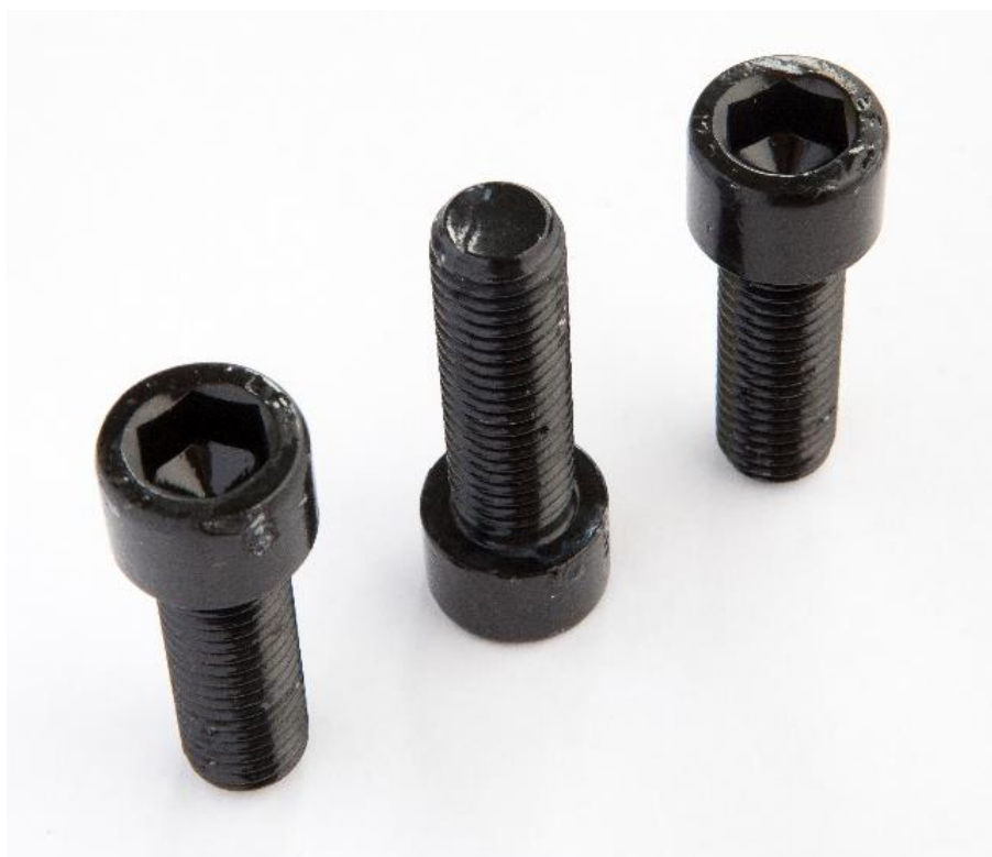
Obrázek 12 - Šrouby po 320 hodinách v NSS
