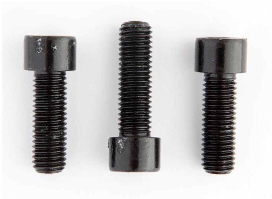
Obrázek 11 - Šrouby po 320 hodinách NSS
