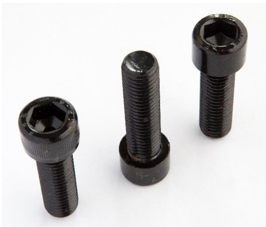
Obrázek 24 - Šrouby po 320 hodinách NSS
