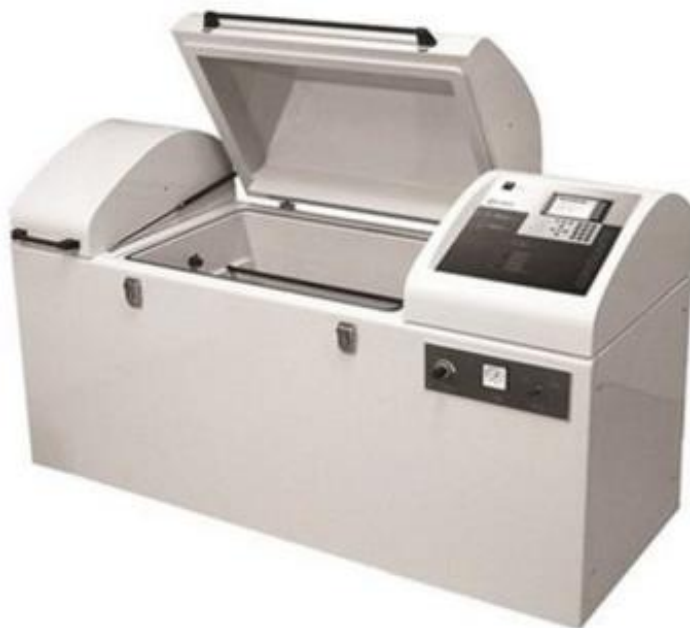
Obrázek 8 - Zařízení Liebisch SKB400ATR vhodné pro zkoušku NSS [28]
