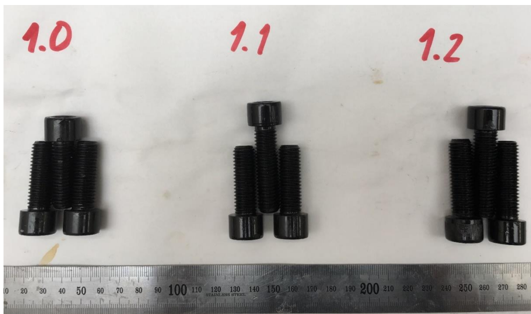
Obrázek 33 - Vzorok šroubů po 144 hodinách v NSS
