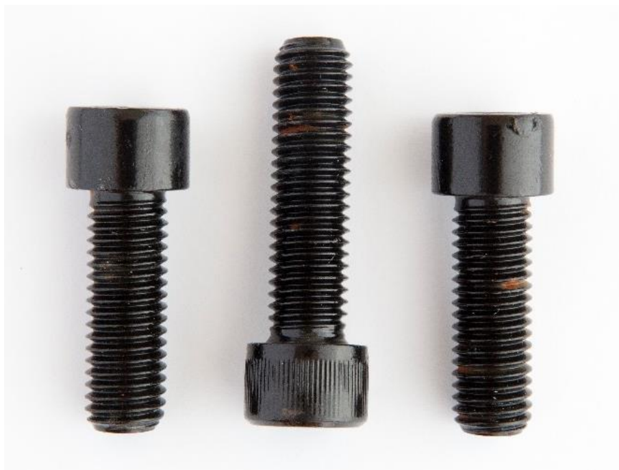
Obrázek 17 - Šrouby po 320 hodinách v NSS
