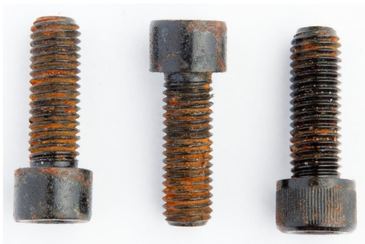
Obrázek 27- Šrouby po 240 hodinách v NSS (Pouze mořeny + KTL)
