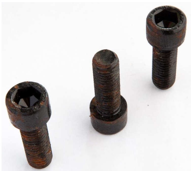
Obrázek 28 - Šrouby po 240 hodinách v NSS (Pouze mořeny + KTL)
