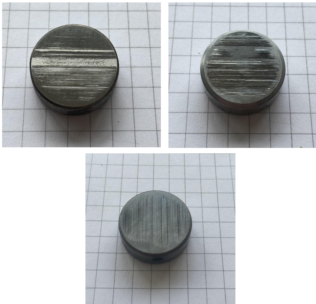
Obr. 19, 20 a 21: Snímky tablet po suchém tření, v pořadí ocel – ocel, ocel – TiN a ocel – teflon
