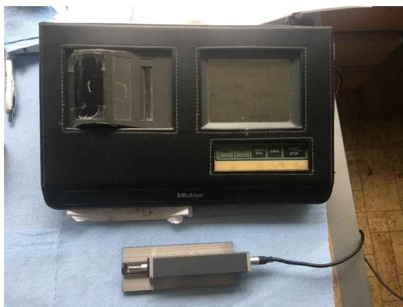
Obr. 17: Drsnoměr Mitutoyo SJ-301
