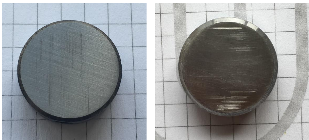
Obr. 22 a 23: Snímky tablet po tření s olejem, v pořadí ocel – ocel, ocel – TiN
