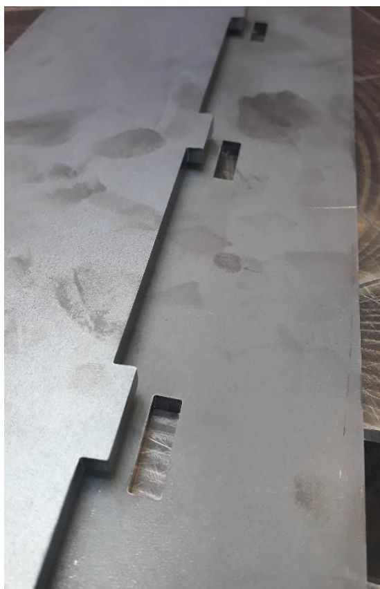
Obrázek 3 – Fixační zámky zhotovené pomocí CNC laseru
