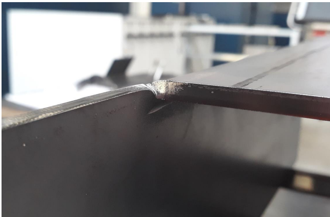
Obrázek 26 - Deformace způsobená špatným návrhem rozvinu
