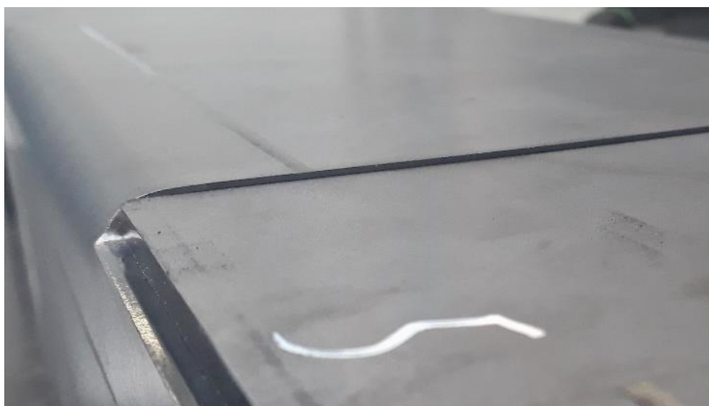
Obrázek 28 - Výsledný propad při použití původního 5 mm plechu pro T-profil činil 0,8mm
