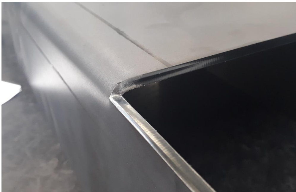
Obrázek 29 - Správně zhotovený přechod v ose ohybu
