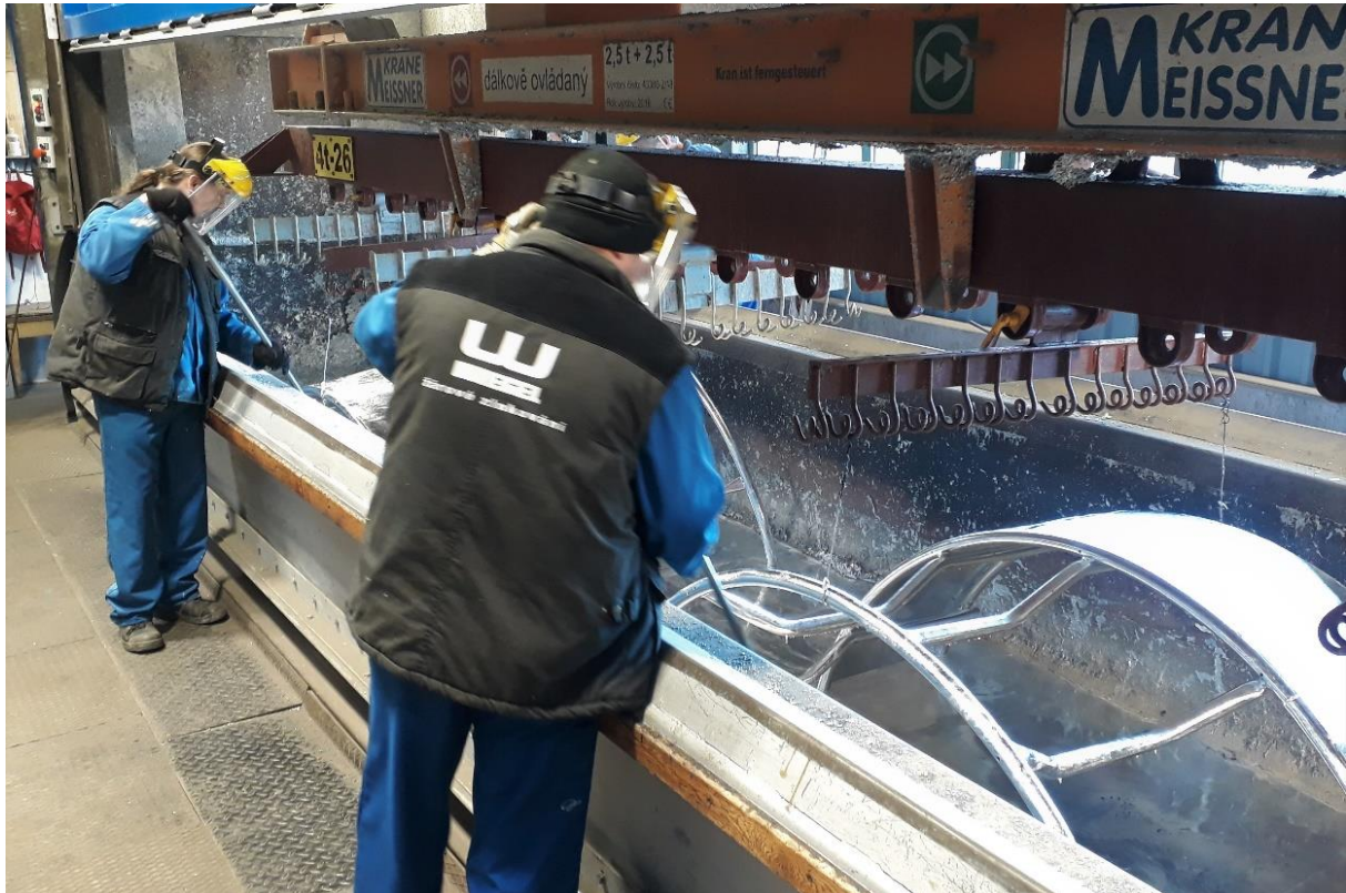
Obrázek 12 - Žárové zinkování ve společnosti Wiegel
