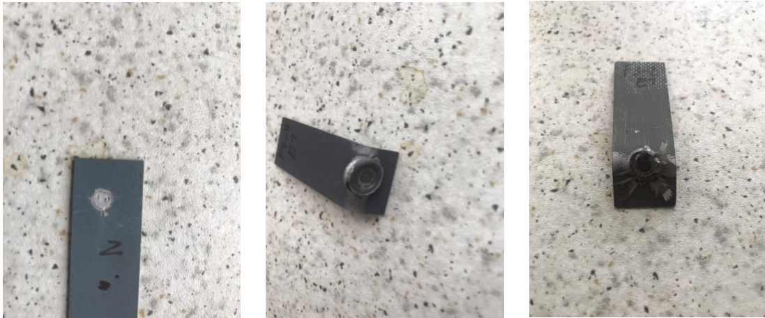
Obr. 3.7: Vady bodových spojů: zleva porušení v dělicí rovině vlivem vnitřních vad, kvalitní svar, nadměrný rozstřík vlivem špatných nastavených parametrů
