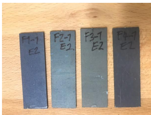
Obr. 5.2.1: Změna barvy oxidů na povrchu
