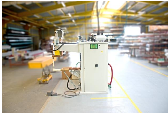
Obr. 3.8: Bodový odporový svařovací stroj [15]
