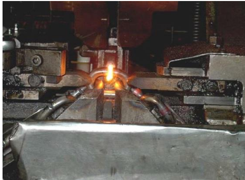
Obr. 3.11: Elektrické odporové svařování řetězů [19]
