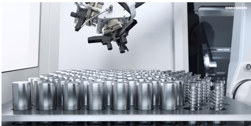
Obr. 12 Pohled na paletu s polotovary a obrobky spolu s dvojitou úchopnou hlavicí [13]
