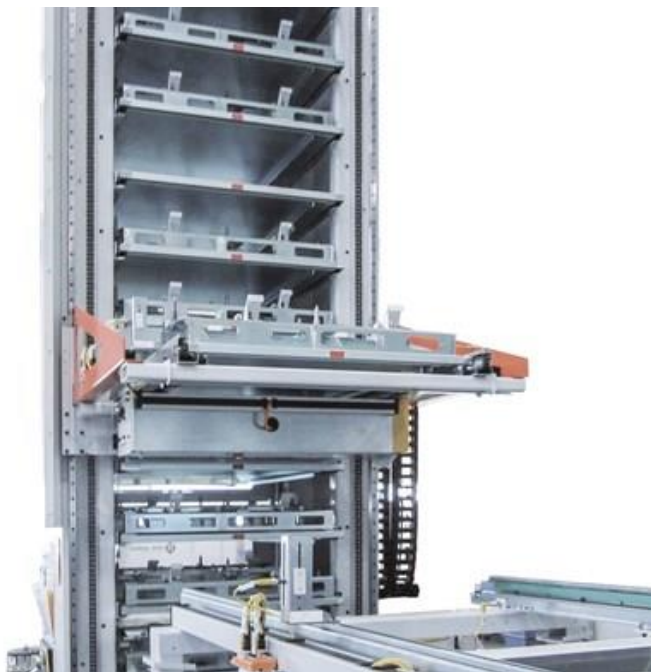
Obr. P3 Věžový paletový zásobník Liebherr EKM 500 [27]
