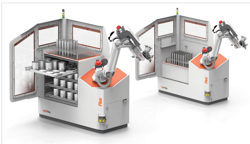
Obr. 8 Agile Flex, dvě možnosti zásobníku, vlevo rozšíření o šuplíky, vpravo box pro delší tyčový materiál [10]
