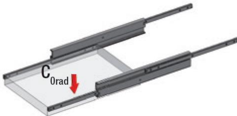
Obr. 31 Schéma zatížení vedení Rollon, pouze radiální zatížení (normálový směr působení zátěžné síly) [20]
