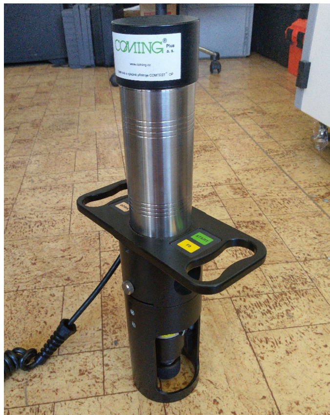
Obrázek 16 – Zařízení pro měření přilnavosti povlaků dle normy ČSN EN ISO 4624
