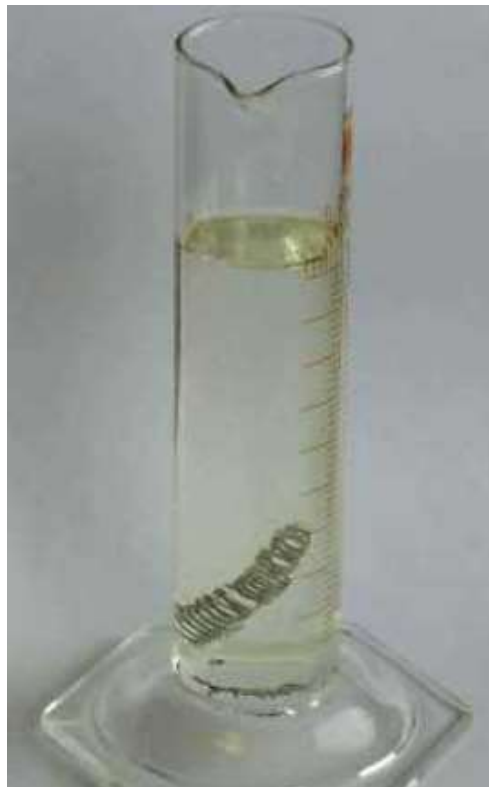
Obrázek 11 – Pojistné kroužky při testu přísad moření [13]
