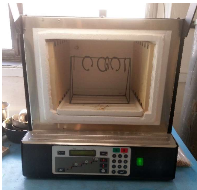
Obrázek 25 – Umístění zkušebních vzorků v peci před žíháním k odstranění vodíkové křehkosti
