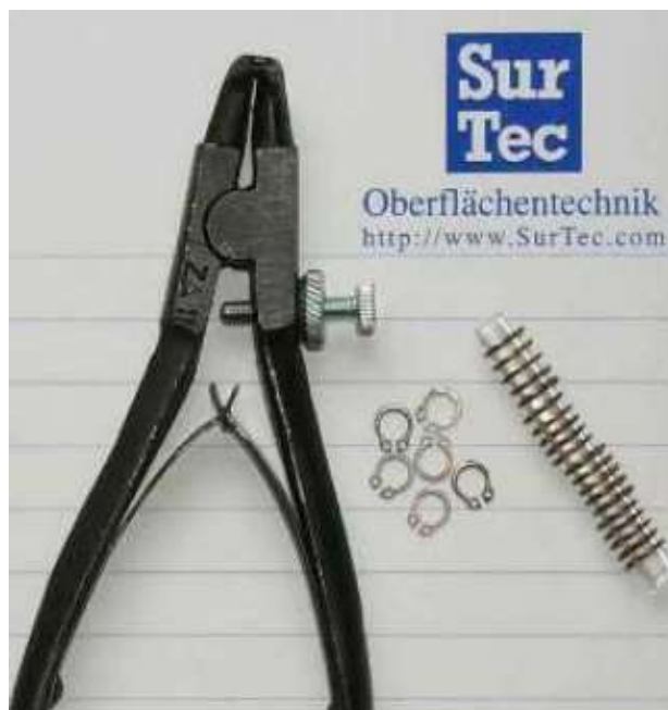
Obrázek 10 – Testovací sada na zkoušení vodíkové křehkosti [13]
