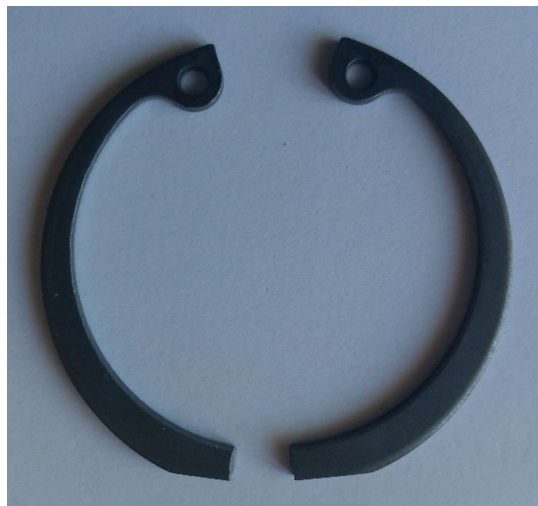
Obrázek 21 – Rozlomený zkušební vzorek po zkoušce na PCN
