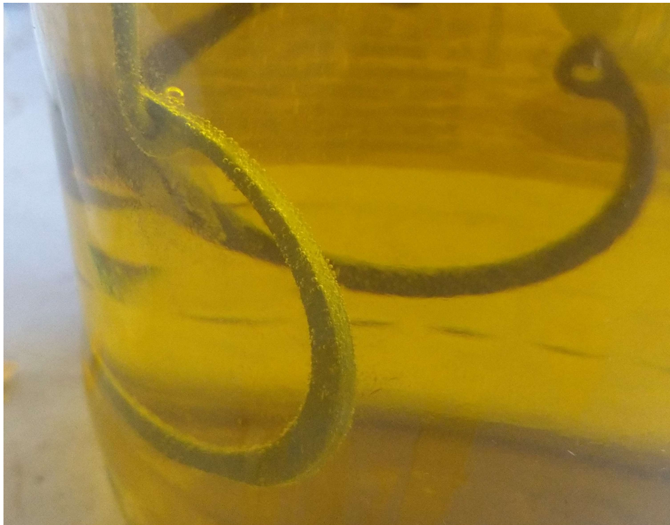
Obrázek 24 – Bublinky vodíku na pojistném kroužku při moření v 15% kyselině HCl
