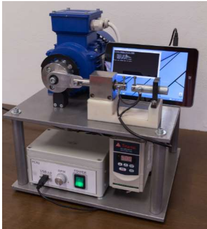
Obrázek 13 – Sestava pulsátoru cyklického namáhání PCN [18]
