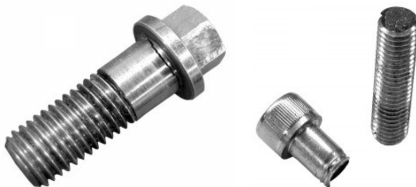
Obrázek 3 – Příklad selhání materiálu příčinou vodíkové křehkosti [15]
