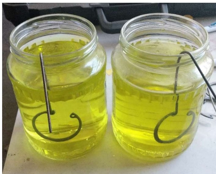
Obrázek 23 – Moření pojistných kroužků v chlorovodíkové kyselině
