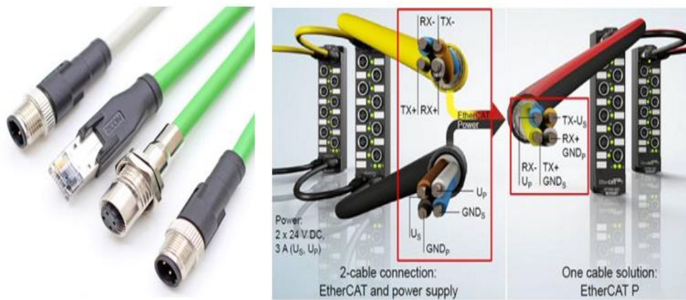
Obrázek 26: Ukázka podporovaných konektorů (vlevo), porovnání zapojení EtherCAT a EtherCAT P (vpravo) [26]
