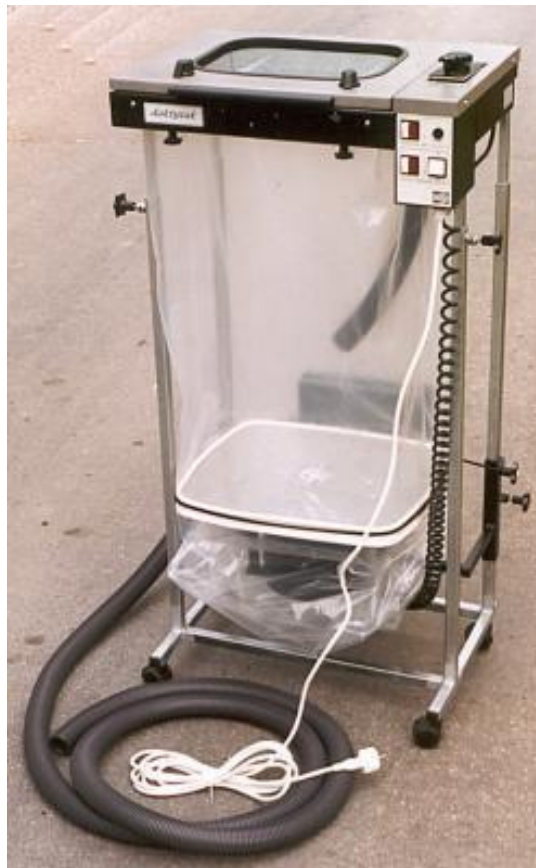
Obrázek 15: Zařízení pro vyvolávání daktyloskopických stop kyanoakrylátovými parami [28]
