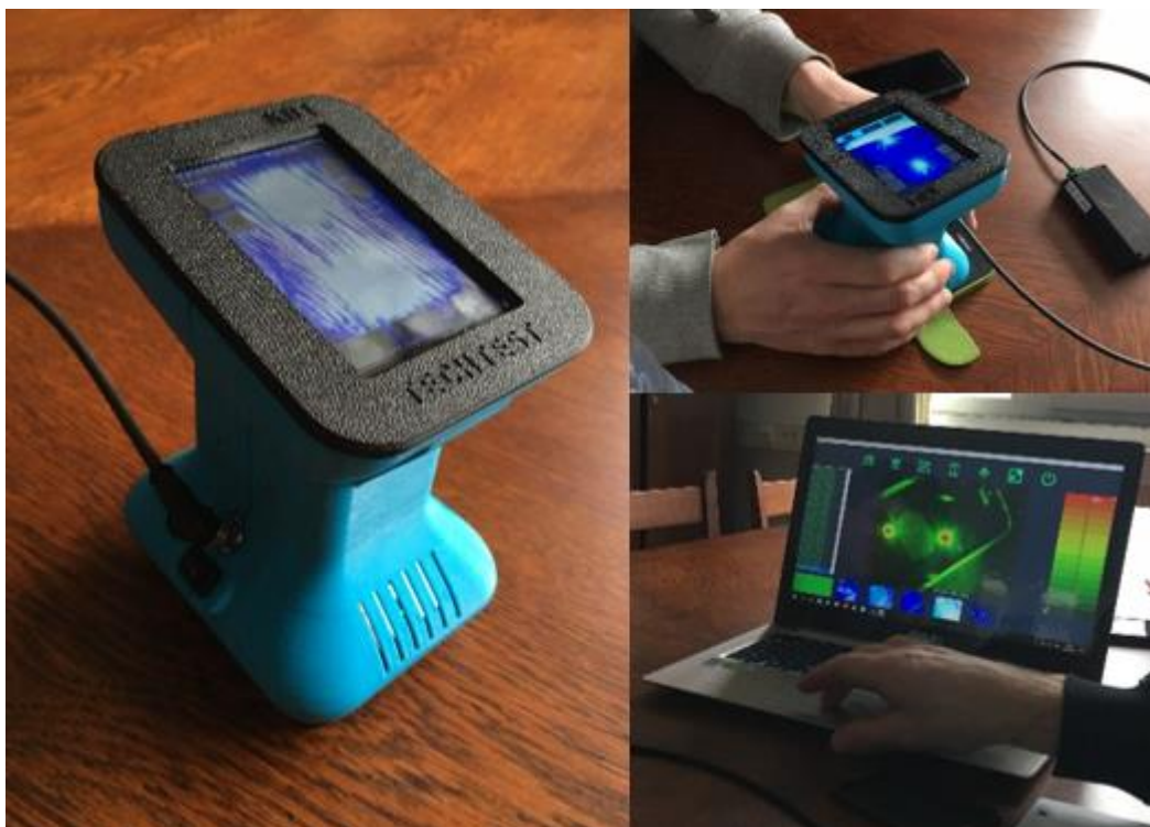
Obrázek 20: Prototyp přístroje pro účinné vyhledávání a zajišťování daktyloskopických stop (2x zdroj UV 365 nm, 2x zdroj bílé světlo)
