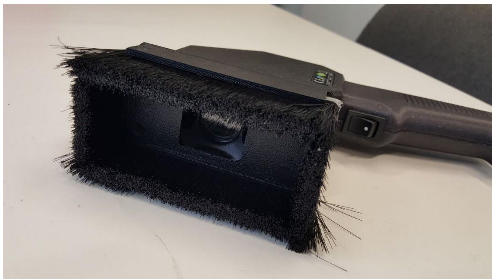
Obrázek 40: Zařízení s předsádkou s výměnnými lištami (dlouhé vlákno osazení)
