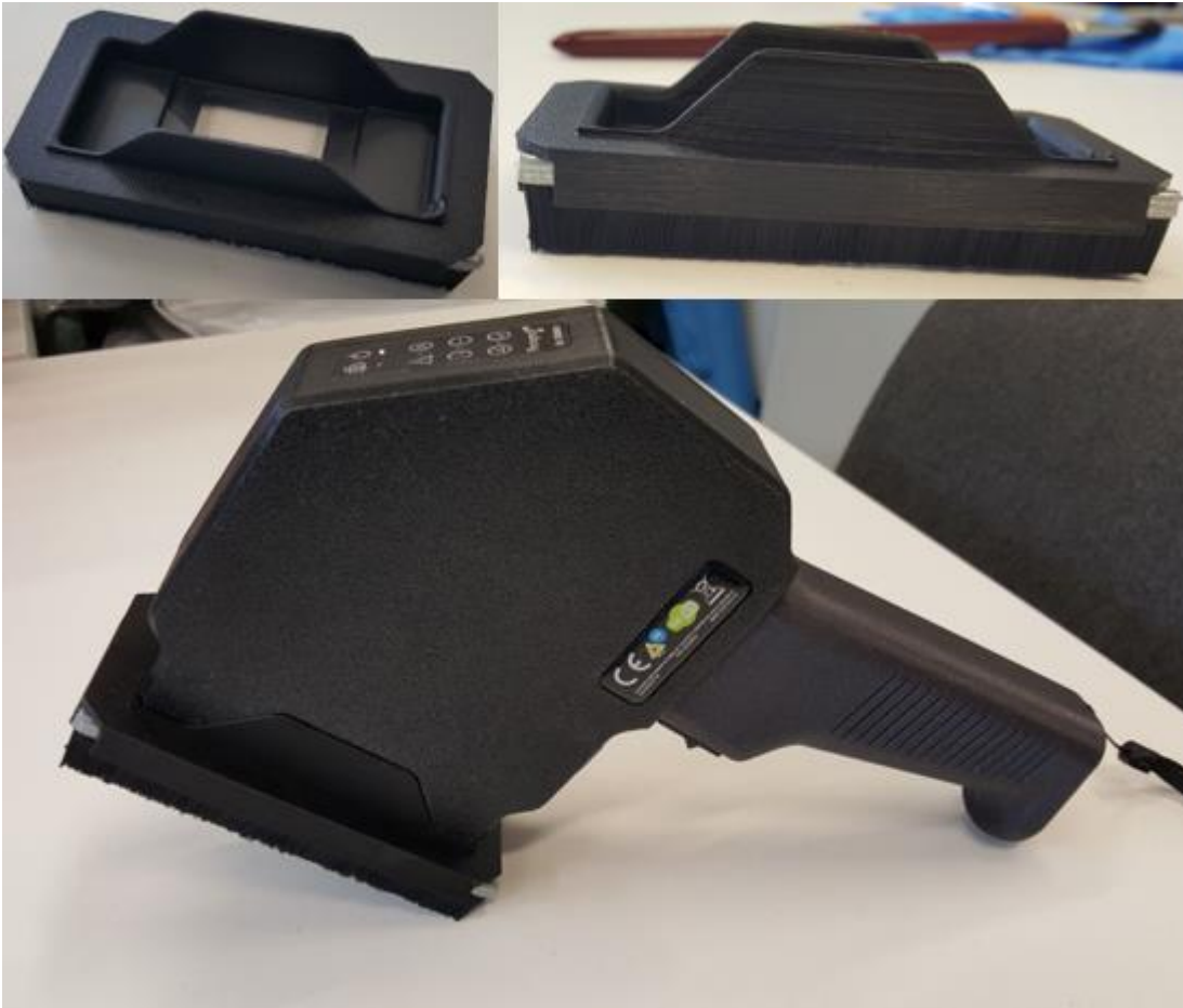
Obrázek 39: Sestavená předsádka s výměnnými lištami a nasazená na zařízení Recognoil
