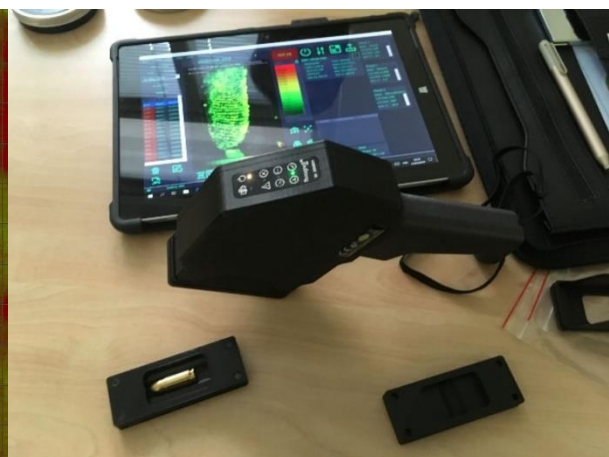
Obrázek 50: Testování nábojnic pomocí speciální předsádky a zařízení Recognoil
