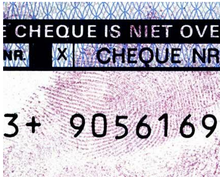
Obrázek 17: Zviditelnění daktyloskopické stopy na šeku pomocí ninhydrinu [30]
