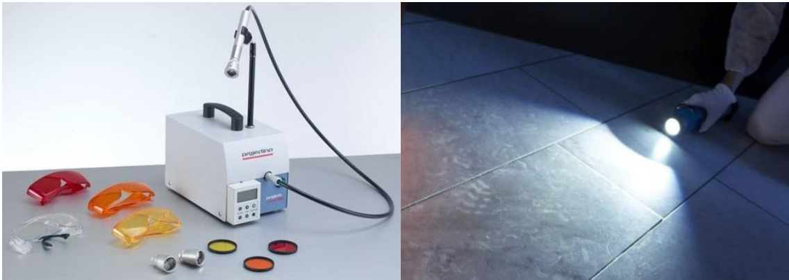
Obrázek 11: Laboratorní světlo MSA-810 PAGLAB [24] Obrázek 12: Hledání stop UV světlem po zatemnění [25]
