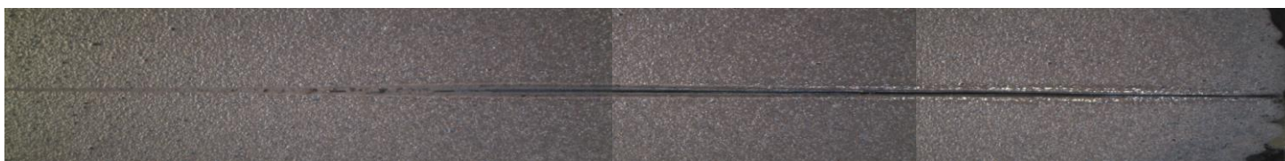
Obrázek 25 - Stopa jehly v povlaku nátěrové hmoty 17410
