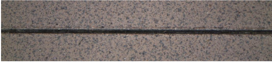
Obrázek 26 - Po celou dobu stejná stopa jehly v povlaku nátěrové hmoty 15570
