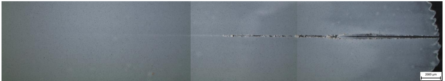
Obrázek 28 - Stopa jehly na povlaku nátěrové hmoty S2328
