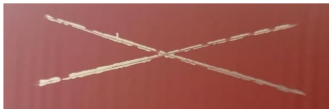
Obrázek 15 - Pvlak z nátěrové hmoty S2220 po zkoušce křížovým řezem
