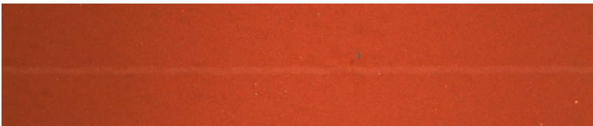
Obrázek 24 - Po celou dobu stejná stopa jehly v povlaku nátěrové hmoty 13770
