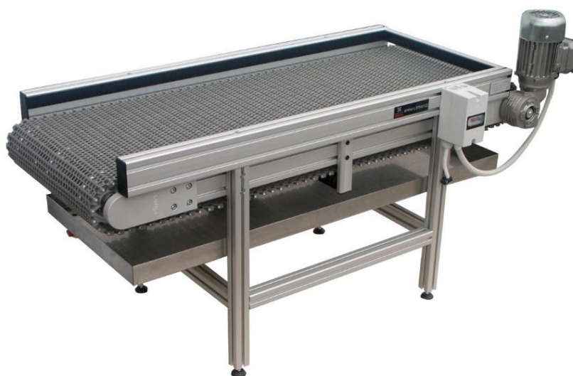
Obr. 3.10 Dopravník s modulárním pásem [15]
