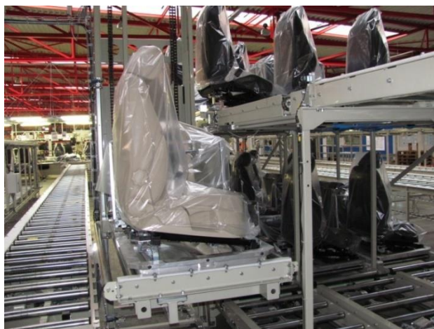
Obr. 3.15 Integrovaný výtah na válečkovém dopravníku [14]
