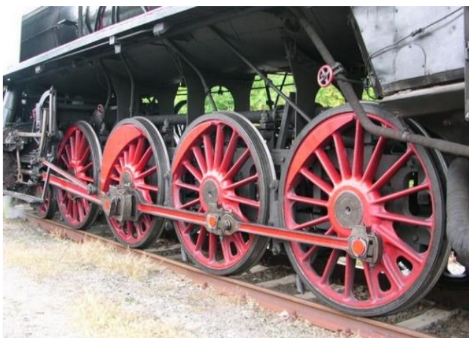
Obrázek 1: Ústřední pohon dvojkolí Lokomotiva 475 [3]
