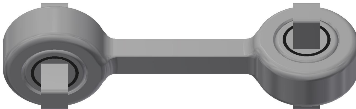
Obrázek 27: Ojnice závěsky, vyrobená z výkovku
