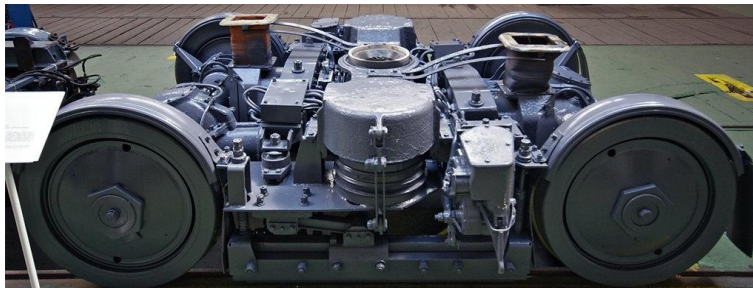
Obr. 10: Podvozek tramvaje Tatra T3, boční pohled [7]
