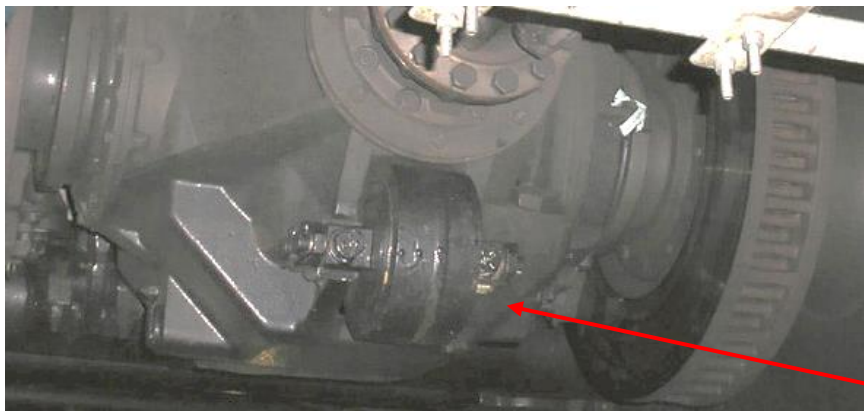
Obr. 17: Uchycení vodorovné závěsky Pendolina [9]
