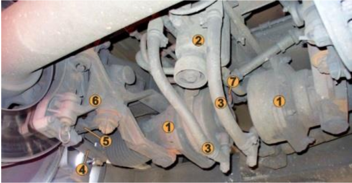
Obrázek 25 Samostatná brzdová jednotka [4]
